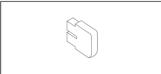
Figure 15. SC Fiber Loopback Plug.
