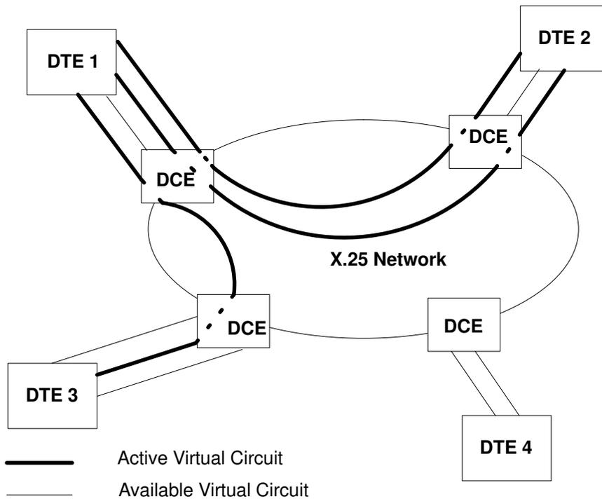
Figure 5. X.25 Network : Virtual Circuits
