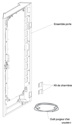
Figure 2. Composants du kit d'options d'échangeur de chaleur pour armoires 610 mm (24 pouces) à rails EIA
