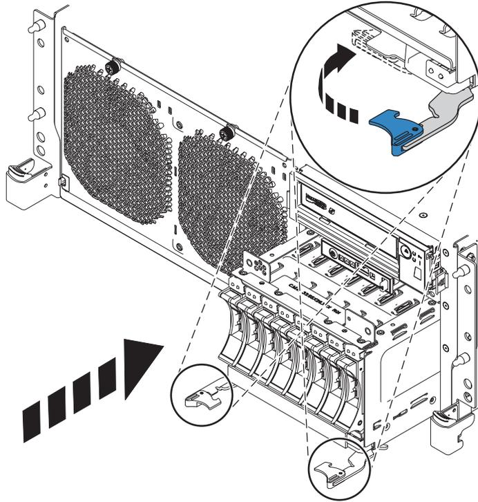
Figure 50. Remplacement du boîtier de l'unité de disque
