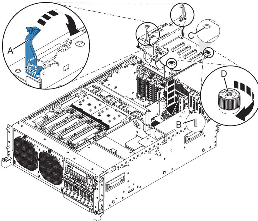
Figure 48. Remplacement de la carte de connexion PCI
