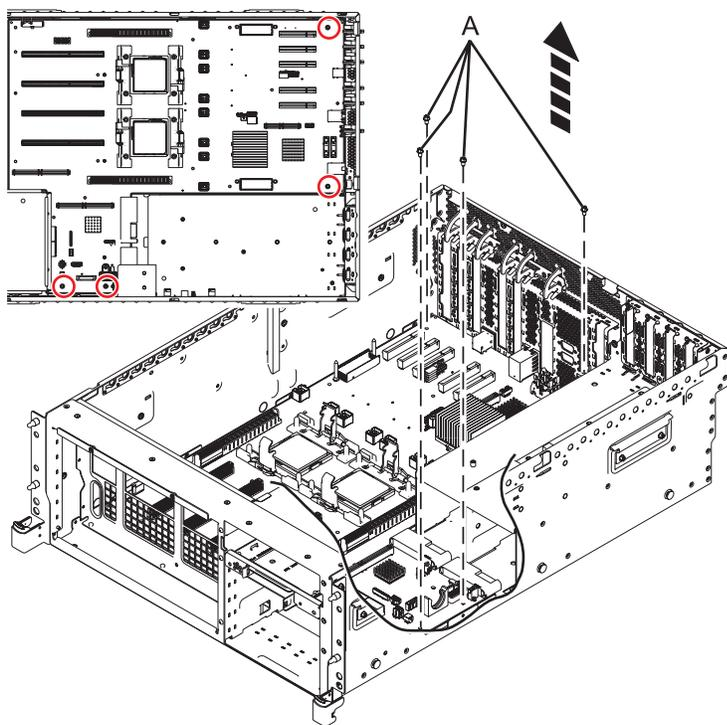
Figure 39. Retrait du fond de panier système du système 02E/4B ou 05F/6B
