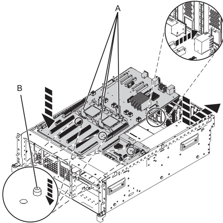
Figure 41. Installation du fond de panier système sur le serveur 02E/4B ou 05F/6B
