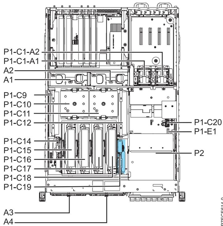
Figure 3. Emplacements de contrôleur de stockage RAID-10 (P1-C19) pour le système 02E/4C, 02E/4D, 05E/6C ou 05E/6D
