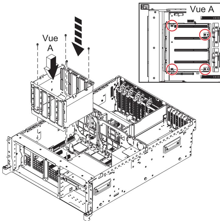
Figure 45. Remplacement du boîtier de barrette DIMM
