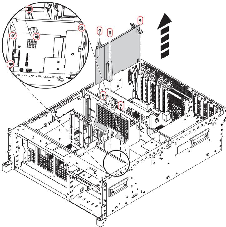
Figure 35. Retrait du boîtier d'unité de disque du système 02E/4C, 02E/4D, 05E/6C ou 05E/6D
