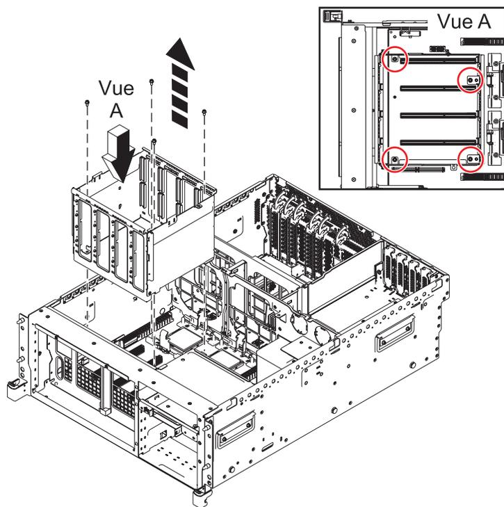
Figure 36. Retrait du boîtier de barrette DIMM
