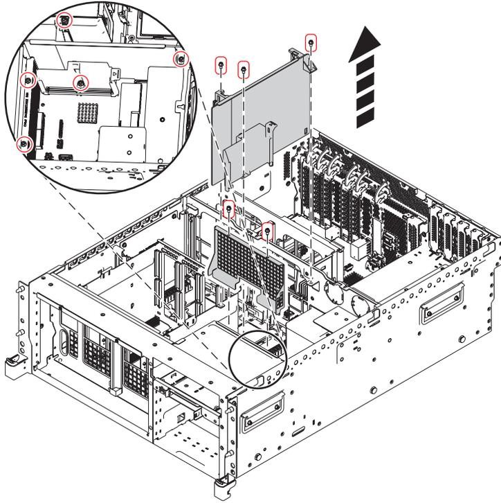
Figure 34. Retrait du boîtier d'unité de disque du système 02E/4B ou 05F/6B
