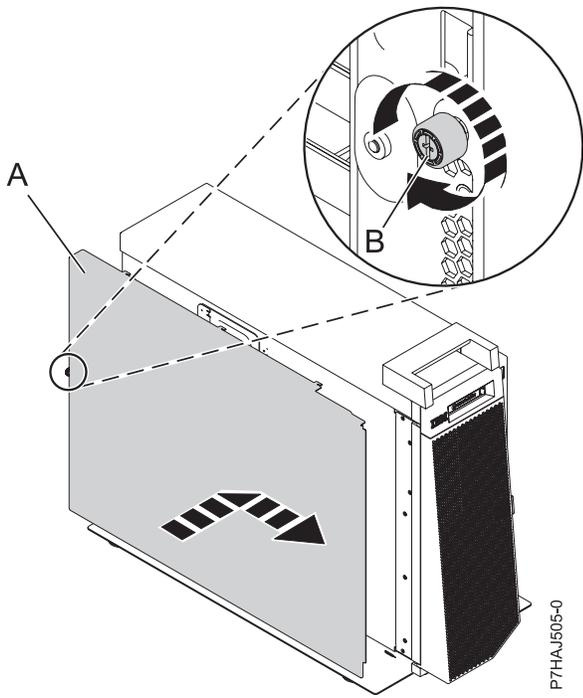
Figure 66. Installation du capot d'accès extérieur
