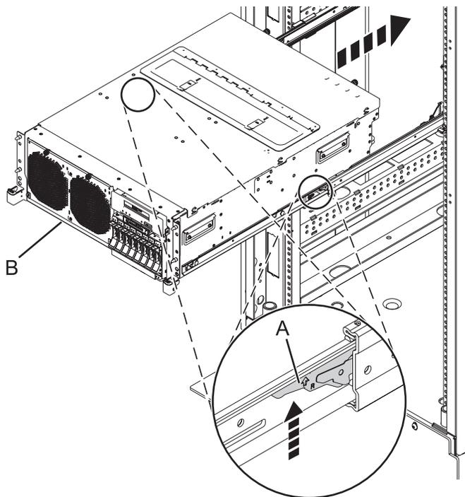
Figure 69. Mise en position de l'unité centrale
