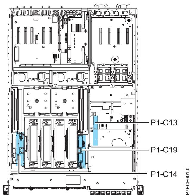
Figure 5. Emplacement pour la carte d'activation RAID, le contrôleur de stockage de cache/RAID et la carte de batterie de cache
