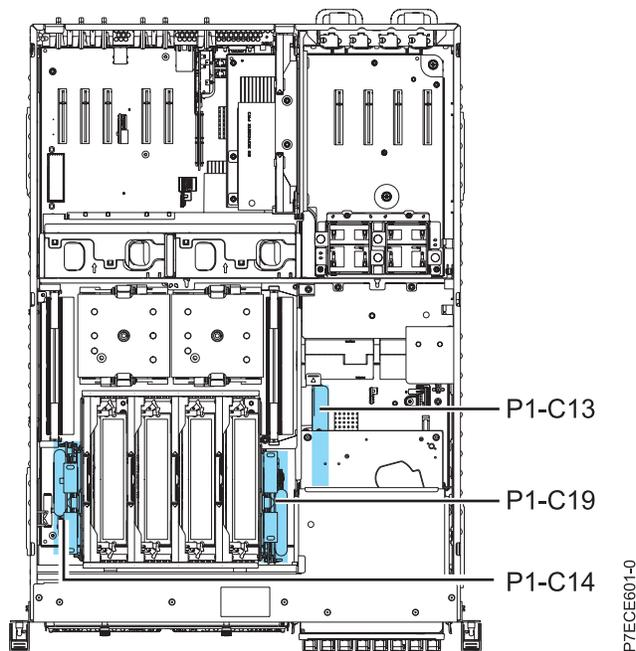
Figure 10. Emplacement de la carte d'activation RAID (P1-C13)
