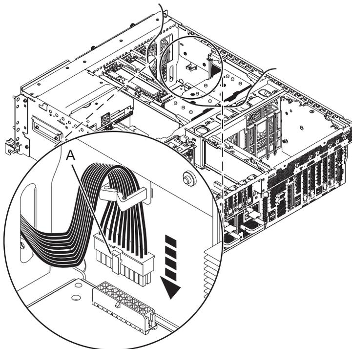
Figure 44. Connexion du câble du ventilateur avant
