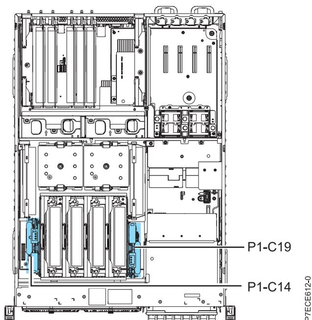
Figure 6. Emplacement pour le contrôleur de stockage de cache/RAID et la carte de batterie de cache
