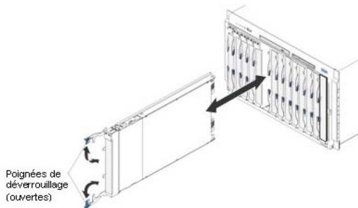
Figure 3-12. Installation du serveur Blade dans un châssis Blade
