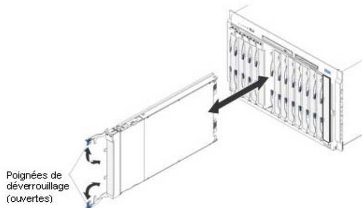
Figure 3-1. Retrait du serveur Blade du châssis Blade
