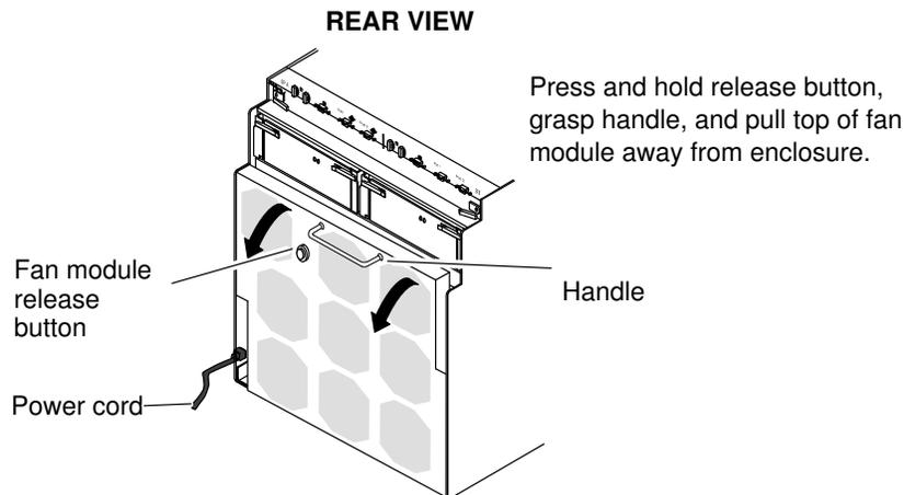
Figure 75. Opening the DAS 3x00 fan module
