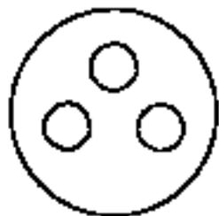
Figure 29. Prise de type PDL
