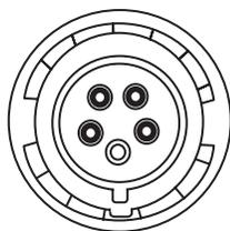
Figure 17. Prise de type IEC 60309 3P+N+E
