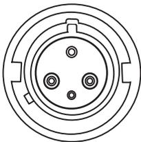
Figure 21. Prise de type IEC 60309 3P+N+E
