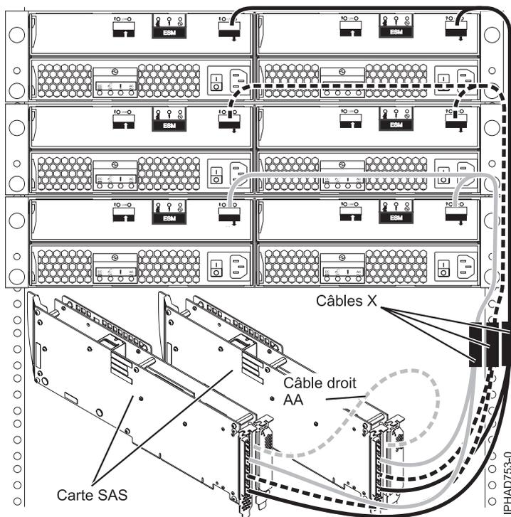
Lors de la connexion de disques durs uniquement, il est possible de mettre en cascade un second tiroir d'extension de disque depuis deux des trois tiroirs pour disposer au maximum de cinq tiroirs d'extension de disque par adaptateur. Voir figure 108, à la page 118.
