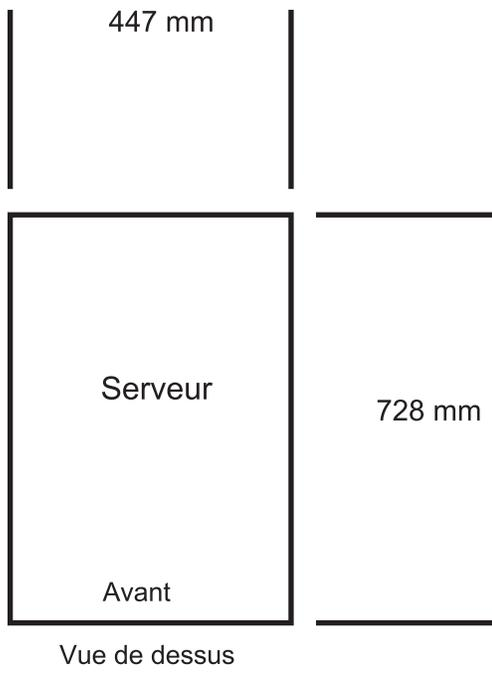
Figure 1. Modèles 31E/2B, 31E/1C et 31E/2C - Vue de dessus (montage en armoire)
