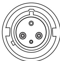
Figure 45. Prise de type IEC 60309 2P+E
