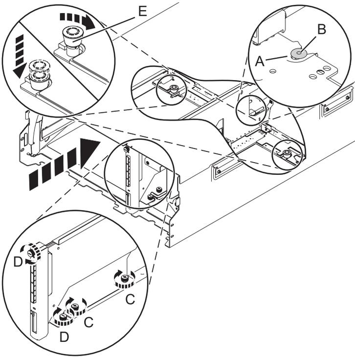
Figure 69. Installation de la carte d'extension SAS et du fond de panier central
