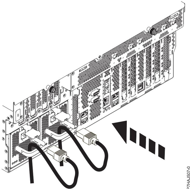
Figure 108. Connexion des cordons d'alimentation
