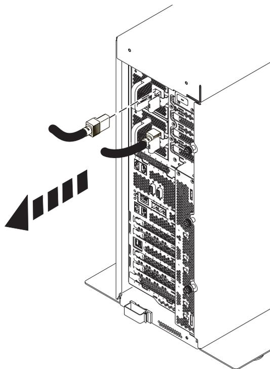
Figure 107. Retrait des cordons d'alimentation pour un système autonome
