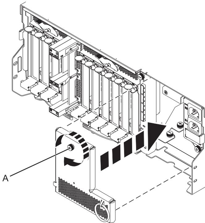
Figure 70. Installation de la plaque d'alimentation
