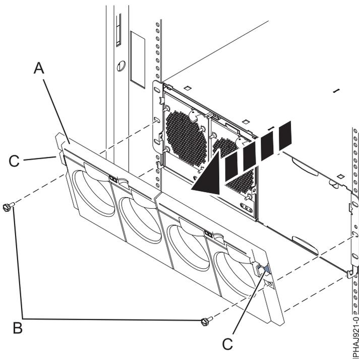
Figure 89. Retrait du capot avant sur un modèle 14G/30
