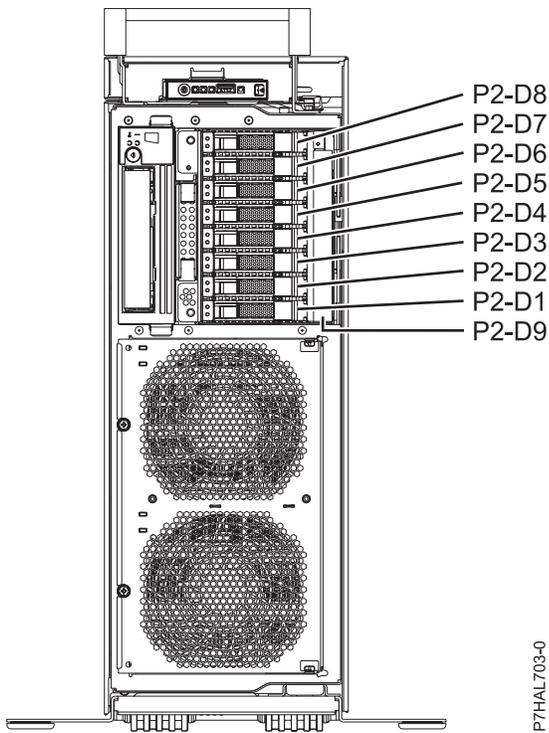
Figure 46. Emplacements des unités de disque sur les systèmes montés en armoire
