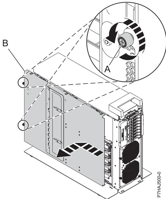
Figure 98. Retrait du capot d'accès intérieur
