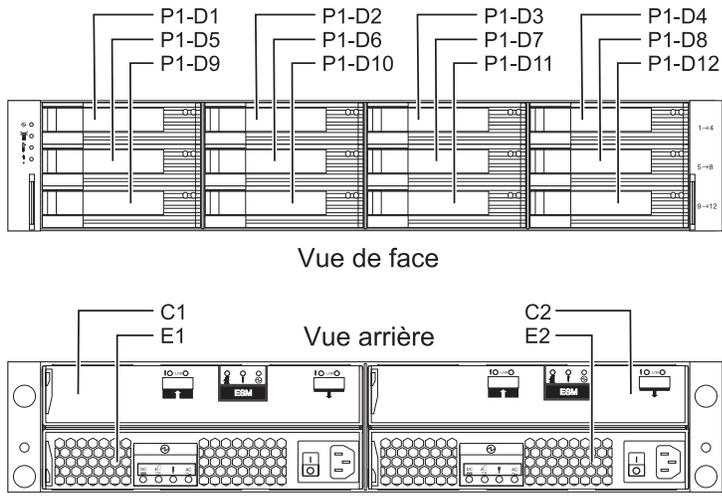
Figure 54. Emplacements des unités de disque sur le boîtier d'unité de disque 58/86
