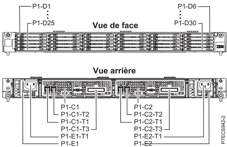
Figure 59. Vues avant et arrière du Boîtier de stockage PCIe 58/88 illustrant les emplacements d'unité SSD
