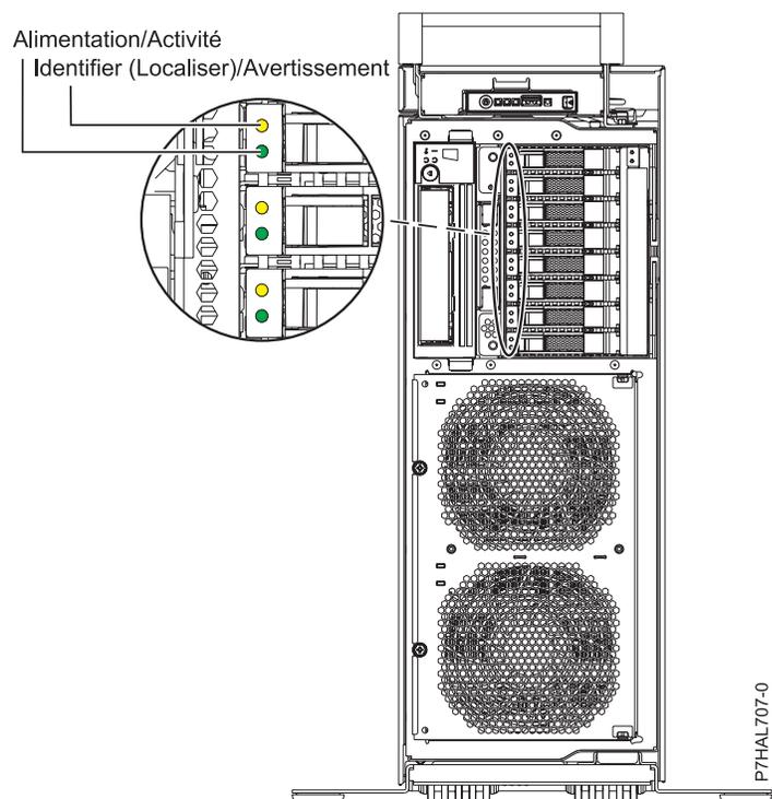
Figure 48. Emplacements des voyants d'activité sur le système autonome
