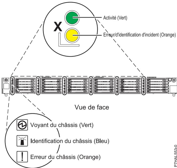
Figure 60. Vue de face du Boîtier de stockage PCIe 58/88 illustrant les voyants d'activité
