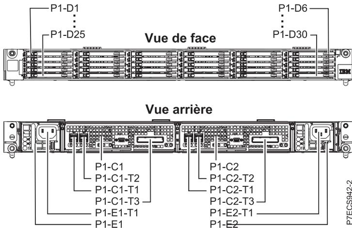
Figure 61. Vues avant et arrière de l'armoire de stockage PCIe ED/R1 illustrant les emplacements d'unité SSD
