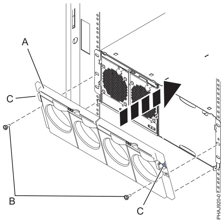
Figure 90. Capot avant d'un modèle 14G/30
