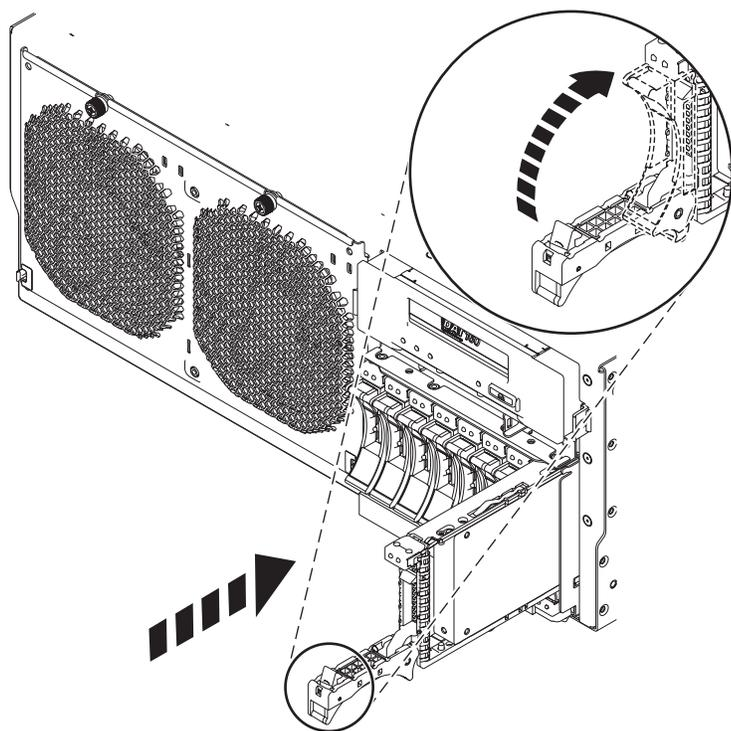
Figure 31. Remplacement d'une unité de disque dans l'unité centrale
