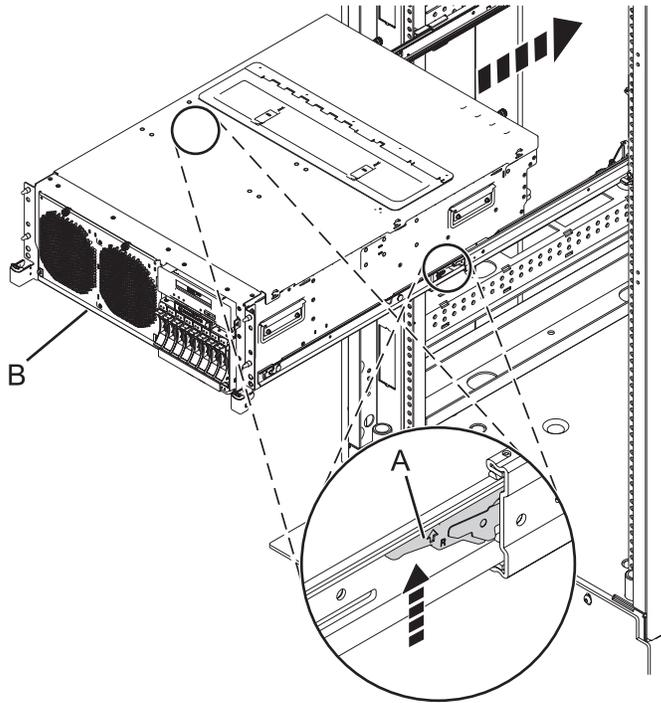
Figure 104. Mise en position de l'unité centrale
