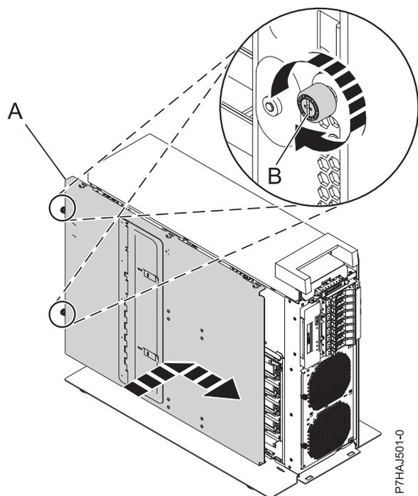
Figure 100. Installation du capot d'accès intérieur
