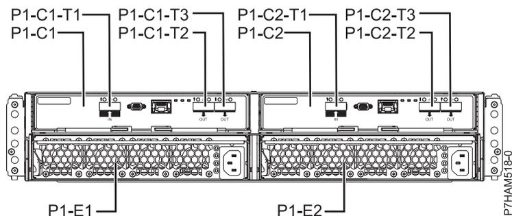
Figure 57. Vue arrière du Boîtier d'unité de disque 58/87
