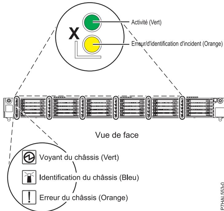
Figure 62. Vue de face de l'armoire de stockage PCIe ED/R1 illustrant les voyants d'activité
