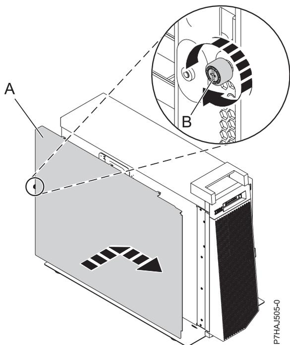
Figure 101. Installation du capot d'accès extérieur
