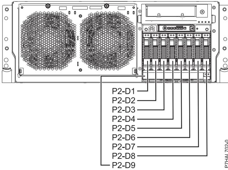
Figure 45. Emplacements des unités de disque sur les systèmes montés en armoire
