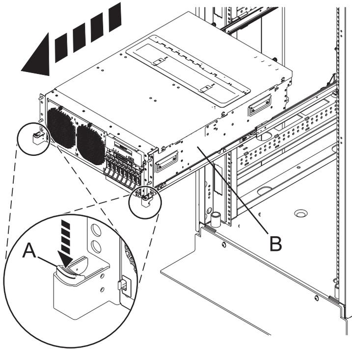
Figure 103. Verrouillage de l'unité centrale en position de maintenance
