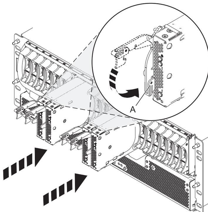
Figure 85. Installation de la d'extension SAS
