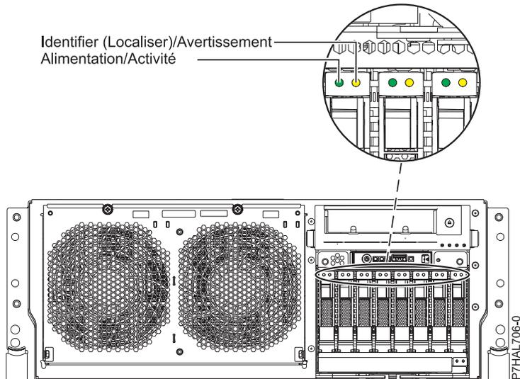
Figure 47. Emplacements des voyants d'activité sur les systèmes montés en armoire
