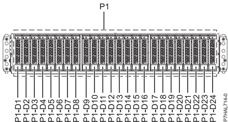
Figure 56. Vue de face du Boîtier d'unité de disque 58/87 illustrant les emplacements des unités de disque
