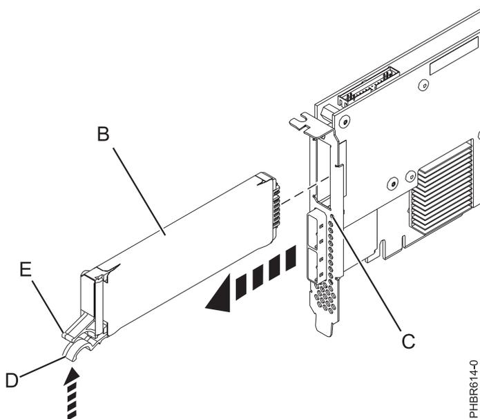
Figure 86. Remplacement de la batterie du cache d'une carte 574E
