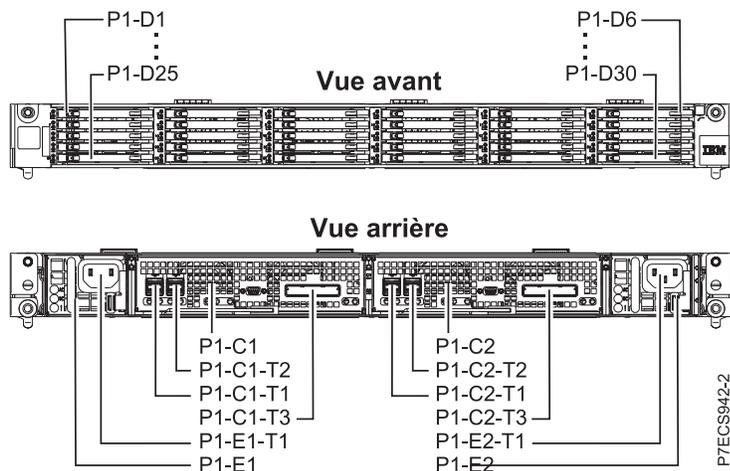
Figure 80. Codes d'emplacement de la carte PCIe2 SAS RAID intégrée avec cache de 3,1 Go
