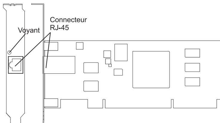
Figure 24. Carte PCI-X TOE iSCSI TX 1 Gbit
