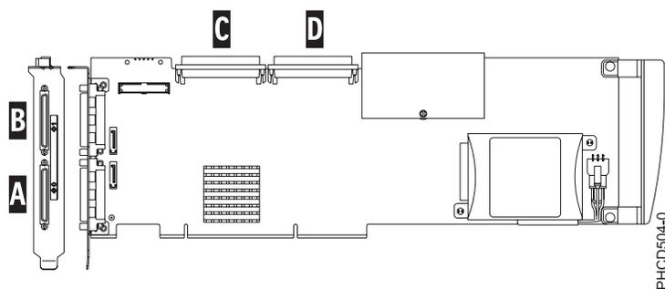
Figure 73. Carte RAID SCSI PCI-X DDR double canal Ultra320
