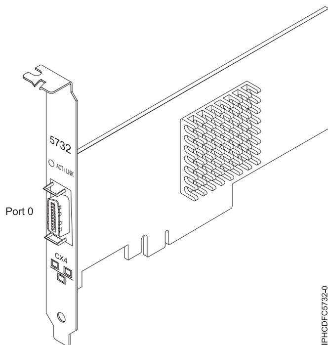
Figure 43. carte PCI Express (PCIe) 10 Gigabit Ethernet-CX4
