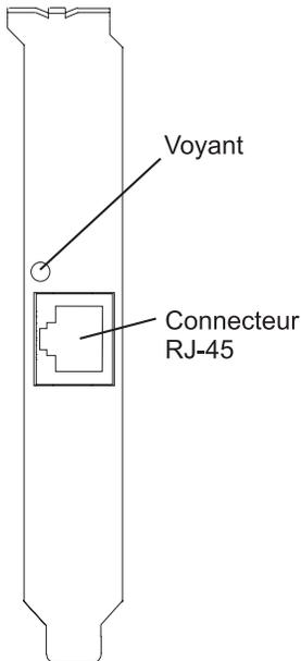
Figure 26. Voyant de la carte PCI-X TOE iSCSI TX 1 Gbit
