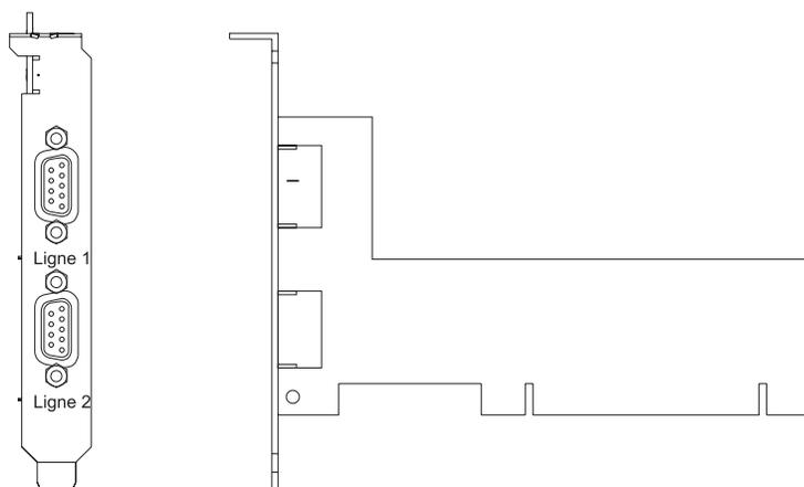
Figure 7. Carte PCI à deux ports asynchrones EIA-232
