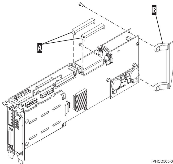
Figure 77. Préparation de la carte pour être placée dans une cassette
