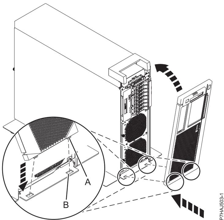
Figure 25. Installation du capot avant
