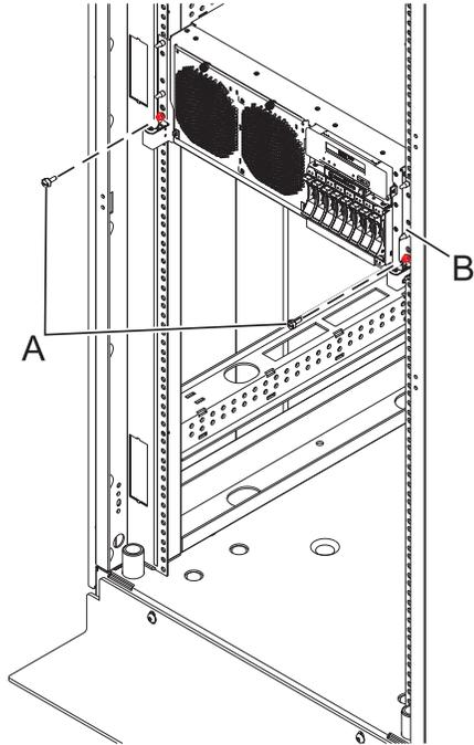
Figure 36. Mise en position de l'unité centrale
