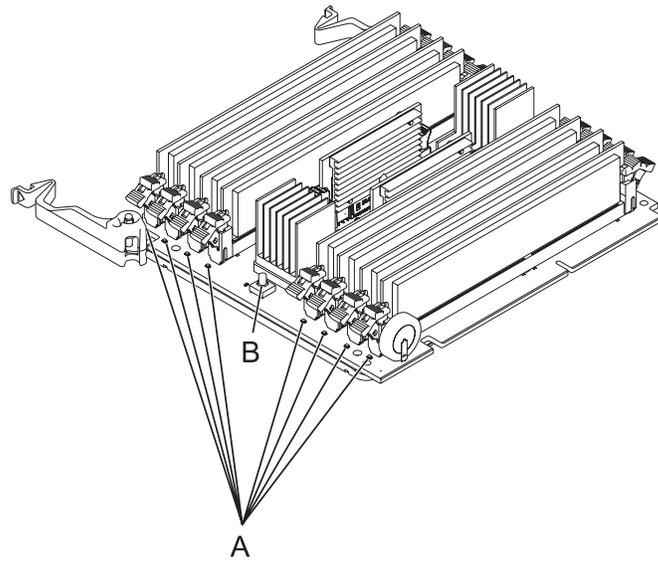
Figure 15. Identification du module de mémoire défaillant
