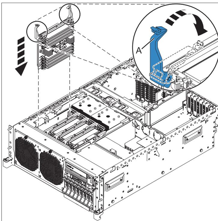
Figure 2. Installation d'une carte d'extension de mémoire
