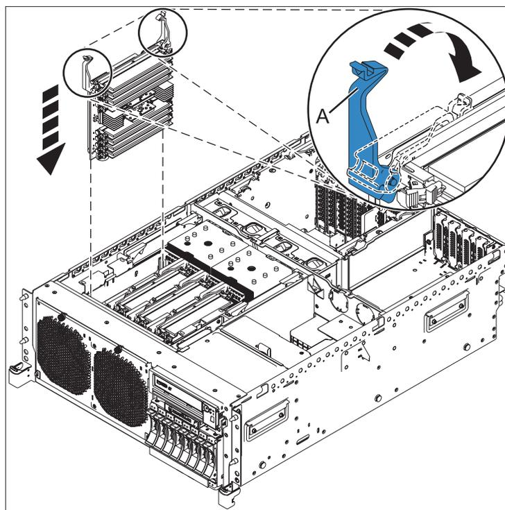
Figure 6. Remplacement d'une carte d'extension de mémoire
