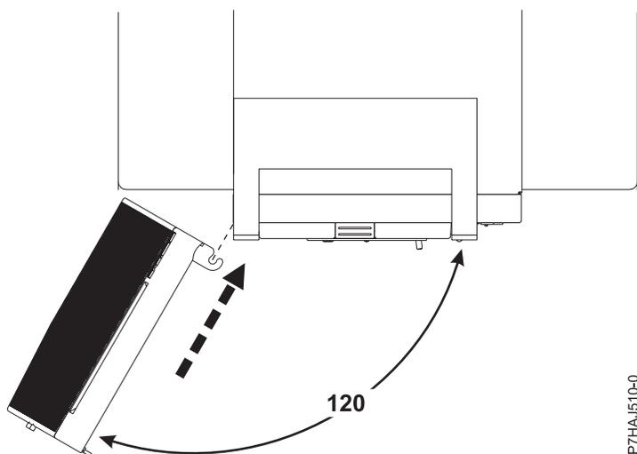
Figure 26. Installation du volet avant
