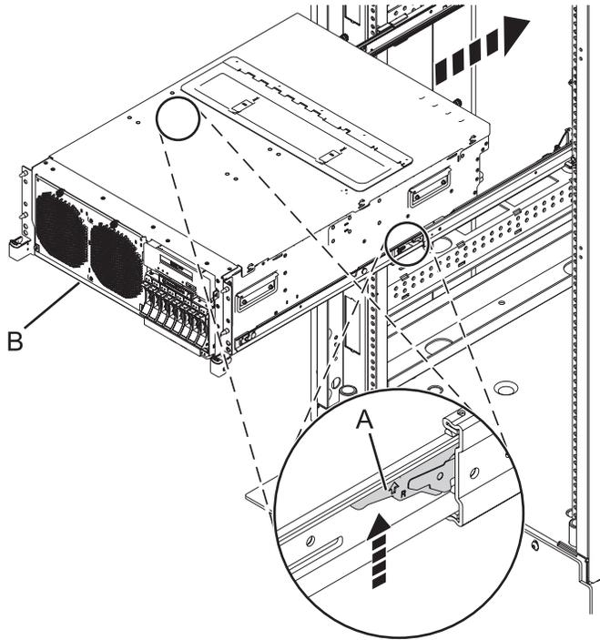
Figure 35. Mise en position de l'unité centrale
