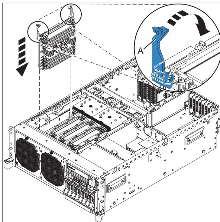
Figure 19. Remplacement d'une carte d'extension de mémoire
