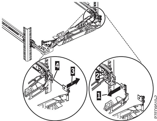
Figure 16. Connexion du bras de routage des câbles
