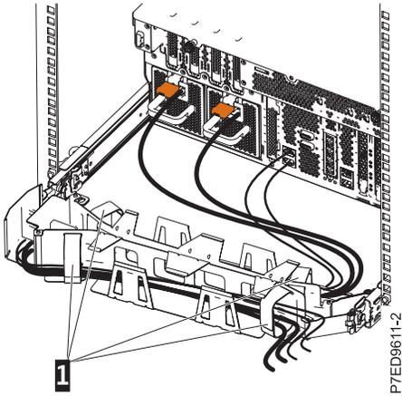
Figure 17. Fixation et routage du cordon d'alimentation
