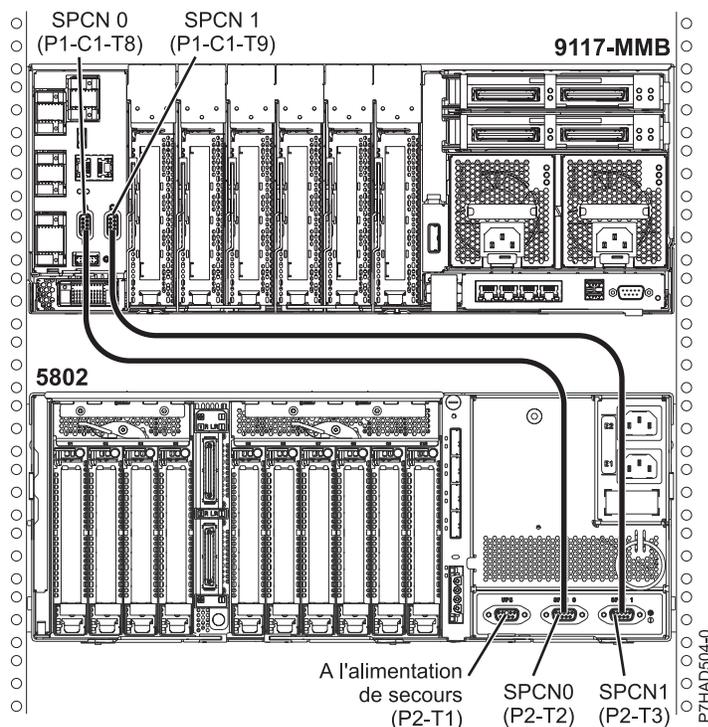
Figure 109. Vue arrière des modèles 17M/MB, 17M/MC, 79M/HB et 79M/HC et 5208 ou 5877 avec l'emplacement d'installation des câbles
