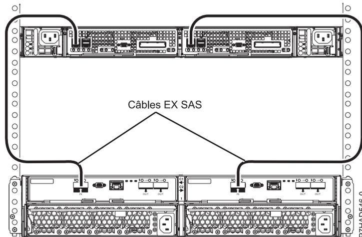
Figure 150. Connexion d'un tiroir 58/87 à l'aide de câbles HD EX vers une armoire EDR1
