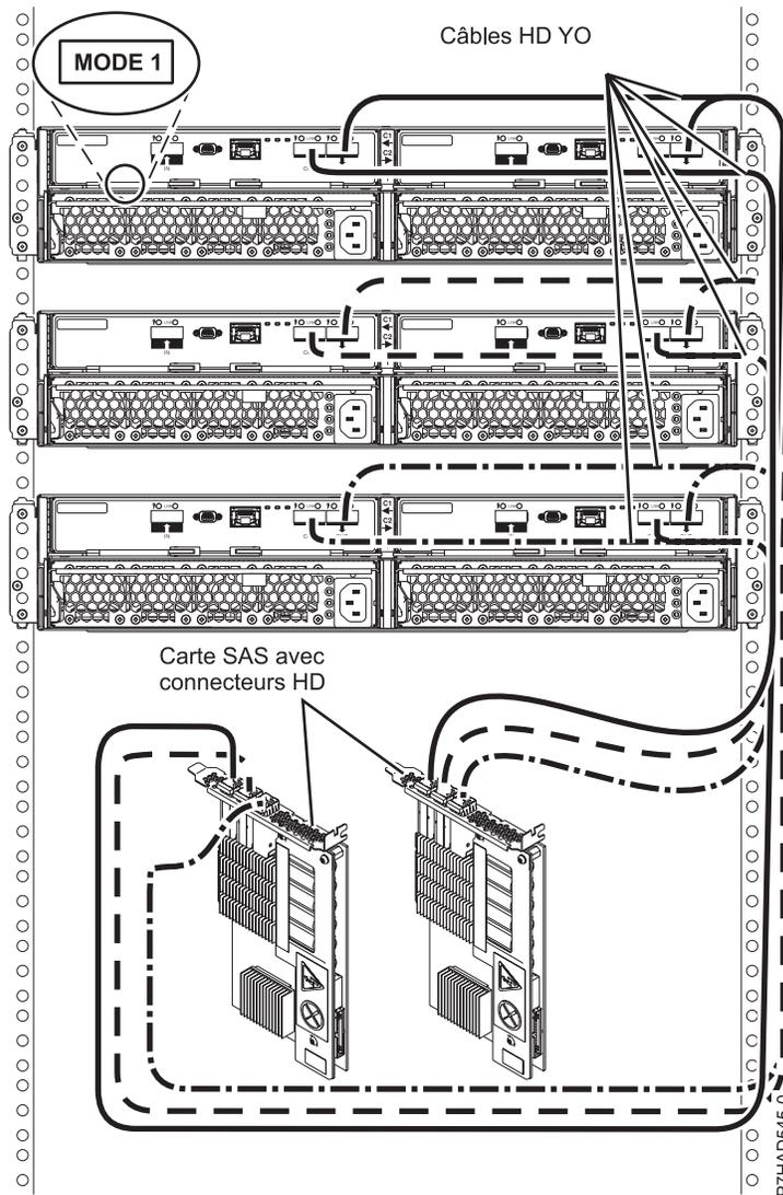
Figure 148. Connexion de mode 1 de trois tiroirs 58/87 via des connecteurs HD à deux cartes SAS
