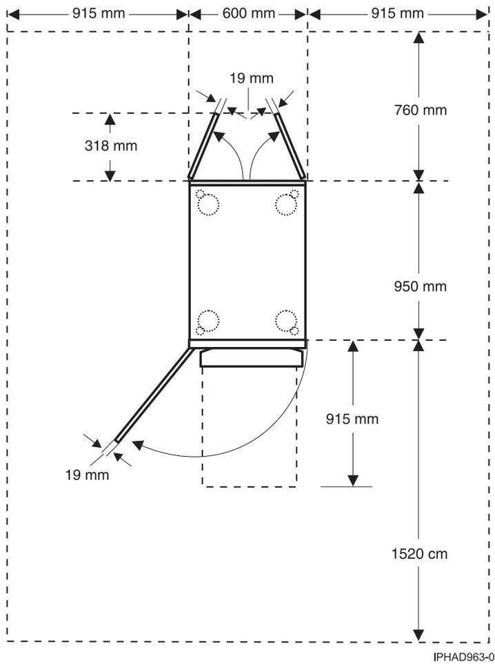
Figure 16. Vue de dessus des modèles 05/55 et 14S/25
