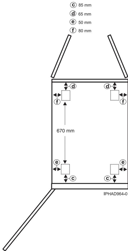
Figure 17. Emplacements des roulettes des modèles 05/55 et 14S/25
