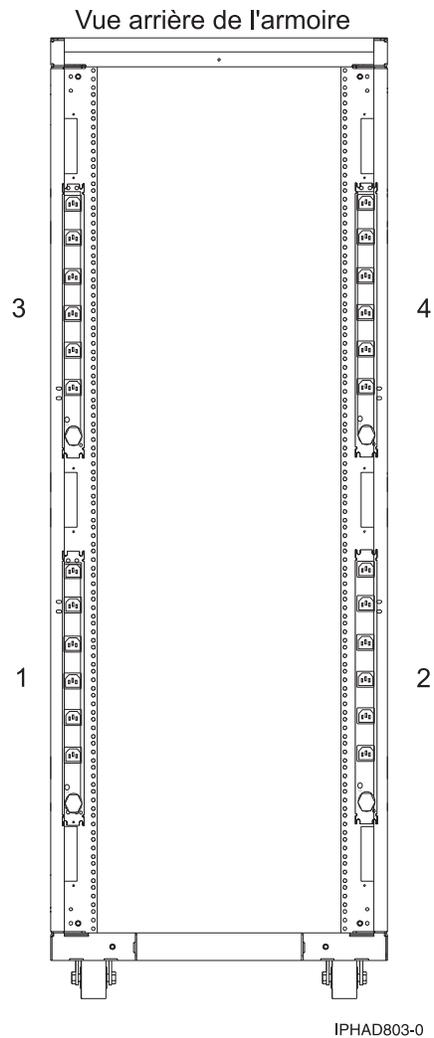
Les unités d'alimentation sont requises dans les armoires 14T/00, 14T/42. Si une unité d'alimentation n'est pas fournie en standard ou commandée, chaque tiroir monté en armoire est livré avec un cordon d'alimentation qui doit être connecté à une prise principale ou à un dispositif interne d'alimentation de secours (UPS) spécifique au pays. Recherchez les cordons d'alimentation appropriés dans les spécifications des tiroirs montés en armoire.
