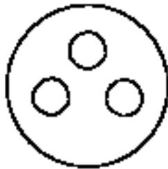
Figure 40. Prise de type PDL
