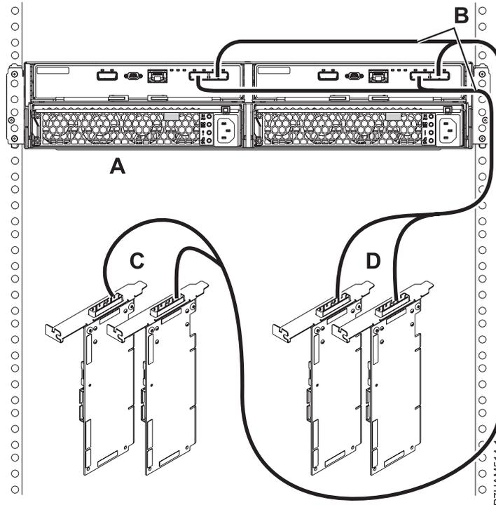
Figure 141. Connexion de mode 2 d'un tiroir 58/87 via des câbles X à quatre cartes SAS (deux paires)
