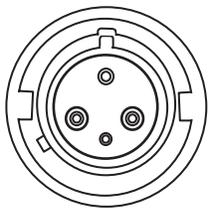
Figure 32. Prise de type IEC 60309 3P+N+E
