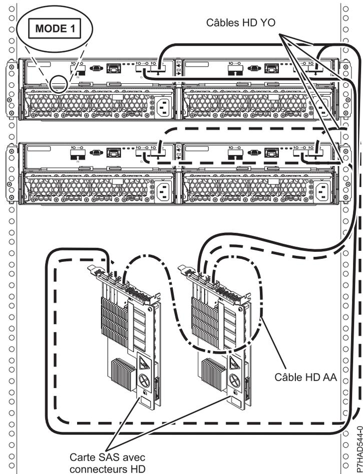
Figure 147. Connexion de mode 1 de deux tiroirs 58/87 via des connecteurs HD à deux cartes SAS
