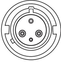
Figure 30. Prise de type IEC 60309 P+N+E
