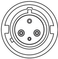
Figure 46. Prise de type IEC 60309 2P+E
