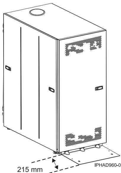
Figure 15. Modèles 05/55 et 14S/25 avec pied de stabilisation
