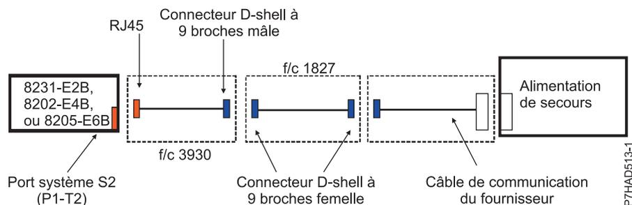
Figure 112. Câblage de l'alimentation de secours pour les modèles 02E/4B, 02E/4C, 05F/6B, 05E/6C, 31E/2B, 31E/1C et 31E/2C
