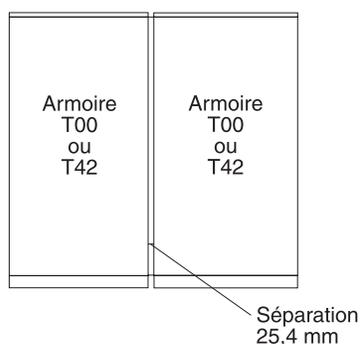
Un kit est proposé à cet effet ; il contient les boulons, les entretoises et les éléments décoratifs de découpe pour cacher la séparation de 25,4 mm entre les armoires. Pour plus d'informations sur les dégagements, voir le tableau correspondant au modèle d'armoire 14T/00.
