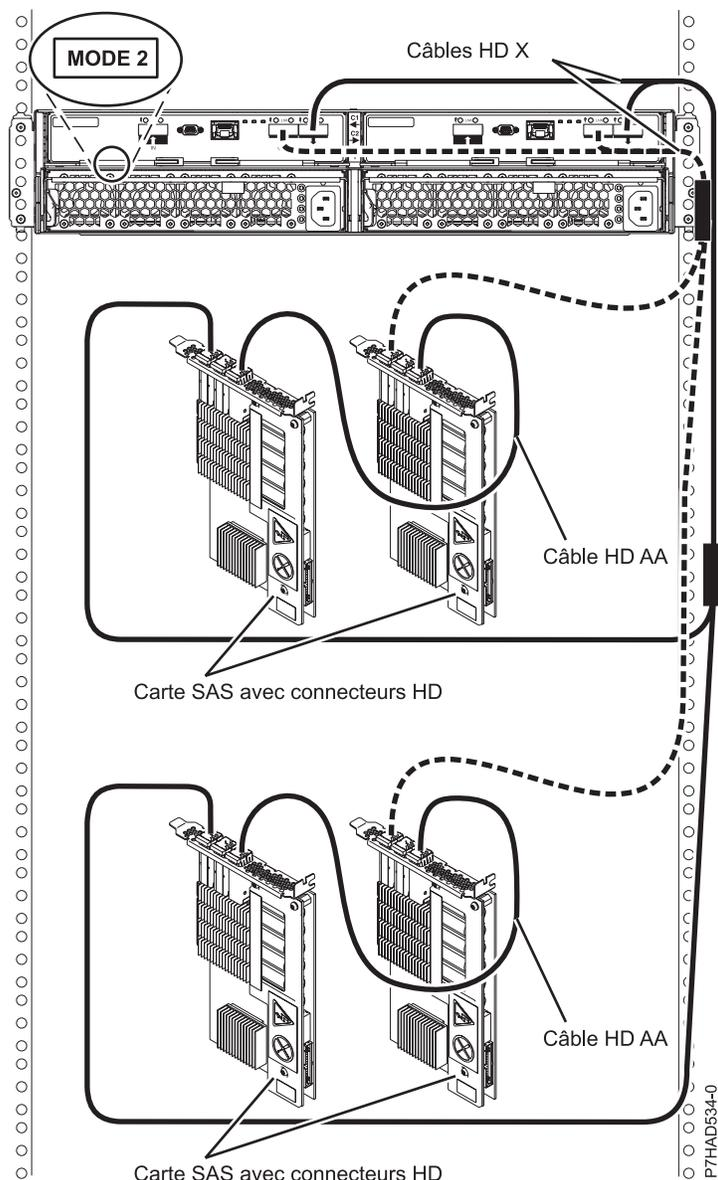
Figure 149. Connexion de mode 2 d'un tiroir 58/87 via des connecteurs HD à deux paires de carte SAS
