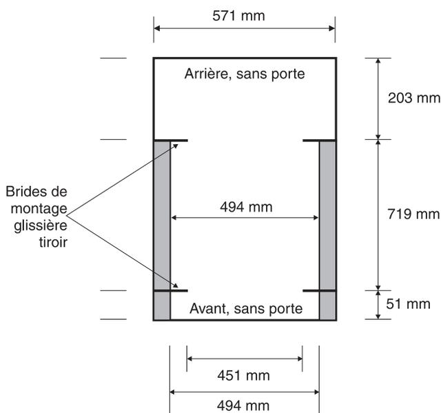
La distance verticale entre les trous de vis de montage doit se composer de trois trous espacés (de bas en haut) de 15,9 mm et de 12,67 mm au centre (ce qui fait que les trois trous verticaux sont à une distance de 44,45 mm du centre). Les cornières de montage avant et arrière de l'armoire doivent être d'une longueur de 719 mm, la largeur interne reliée par les cornières de montage étant d'au moins 494 mm, pour que les rails puissent s'insérer dans votre armoire (voir la figure suivante).
