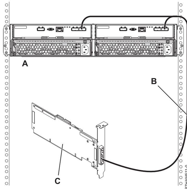
Figure 144. Connexion de mode 1 d'un tiroir 58/87 via un câble YO à une carte SAS unique
