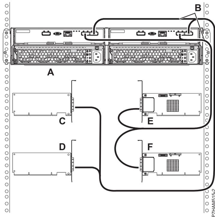
Figure 142. Connexion de mode 4 d'un tiroir 58/87 via des câbles X à quatre cartes SAS
