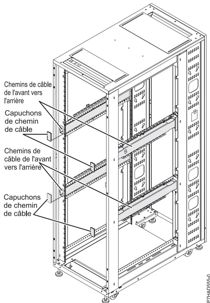
Figure 21. Câblage dans l'armoire
