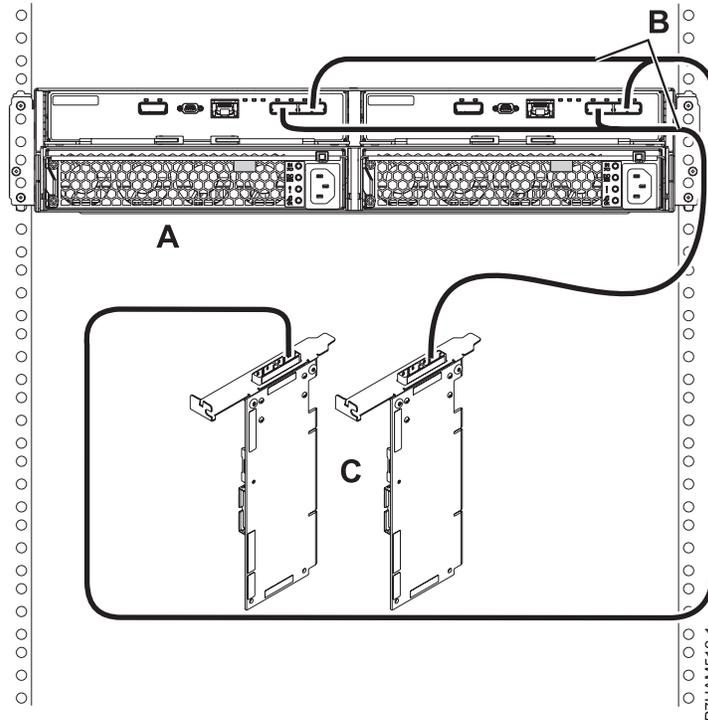
Figure 145. Connexion de mode 1 d'un tiroir 58/87 via des câbles YO à deux cartes SAS
