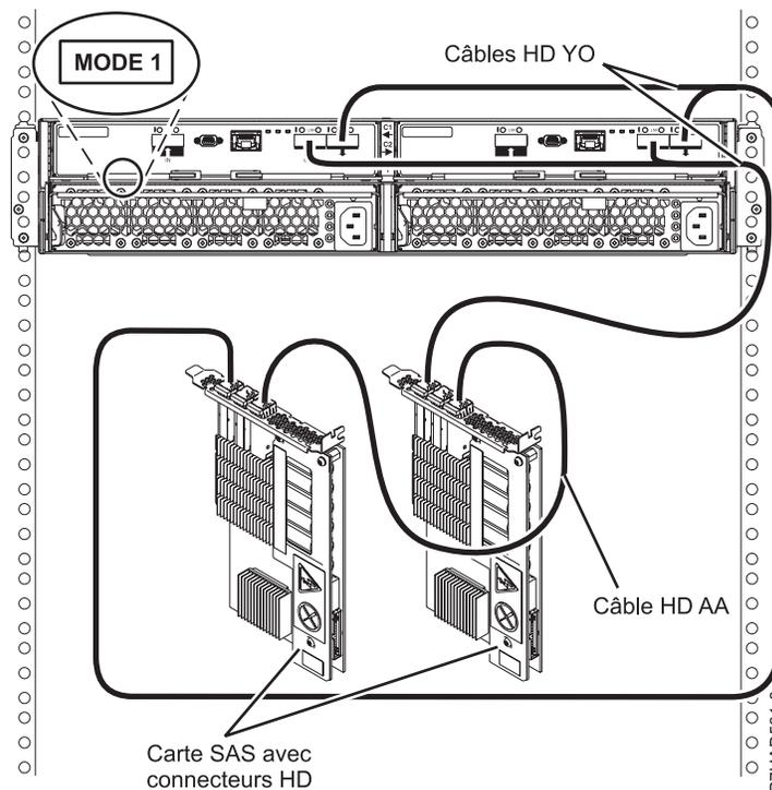
Figure 146. Connexion de mode 1 d'un tiroir 58/87 via des connecteurs HD à deux cartes SAS
