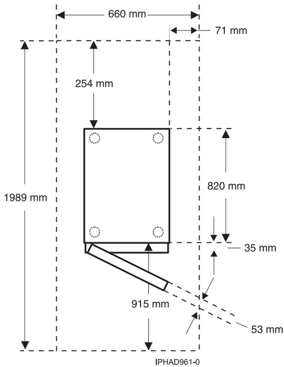
Figure 13. Vue de dessus des modèles 05/54 et 14S/11
