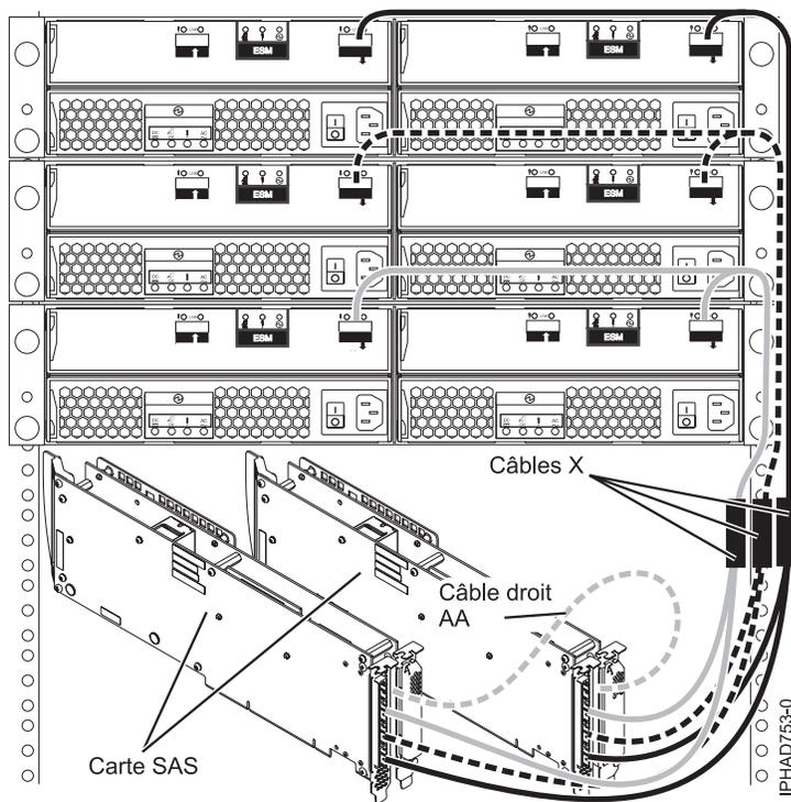
Lors de la connexion de disques durs uniquement, il est possible de mettre en cascade un second tiroir d'extension de disque depuis deux des trois tiroirs pour adapter au maximum de cinq tiroirs d'extension de disque par adaptateur. Voir figure 121, à la page 125.
