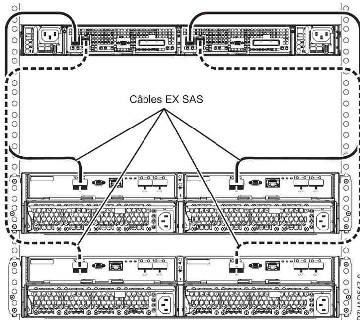
Figure 151. Connexion de deux tiroirs 58/87 à l'aide de câbles HD EX vers une armoire EDR1
