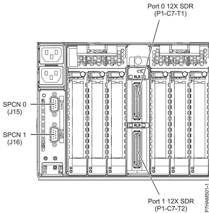
Figure 66. Emplacement des connecteurs sur un modèle 57/96 ou 14G/30
