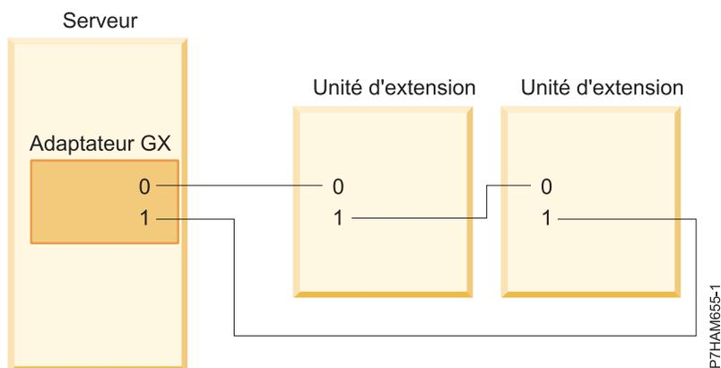
Figure 1. Exemple de serveur doté d'un adaptateur GX connecté à deux unités d'extension
