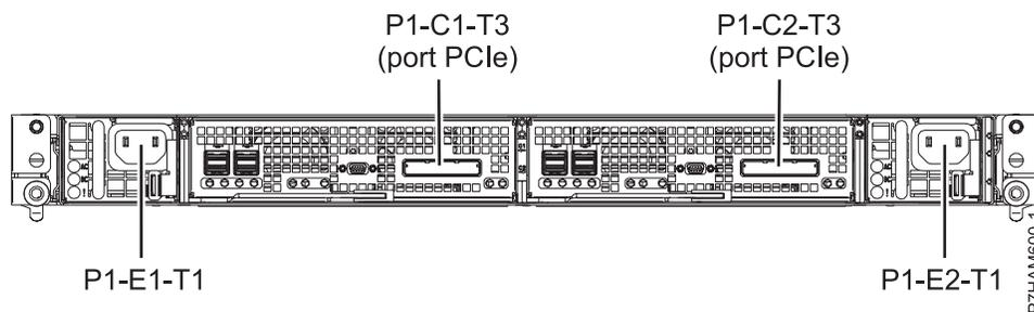
Figure 70. Emplacement des connecteurs sur un modèle 58/88
