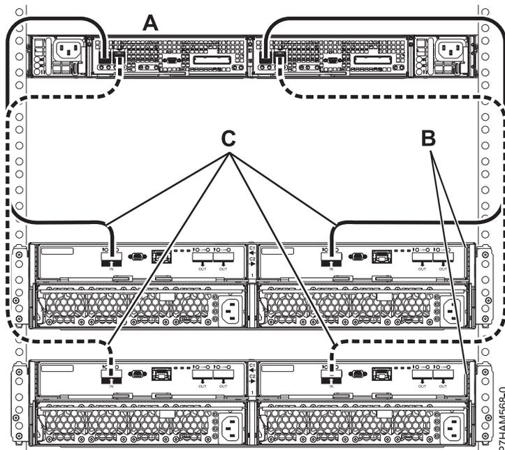
Figure 51. Connexion de deux boîtiers d'unité de disque 58/87 en utilisant des câbles EX reliés à un boîtier de stockage PCIe
