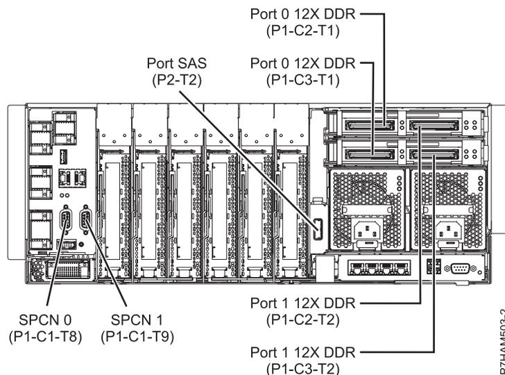
Figure 64. Emplacement des connecteurs sur un modèle 17M/MB ou 79M/HB
