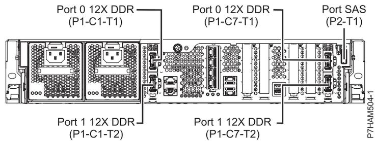
Figure 62. Emplacement des connecteurs sur un modèle 31E/2B monté en armoire
