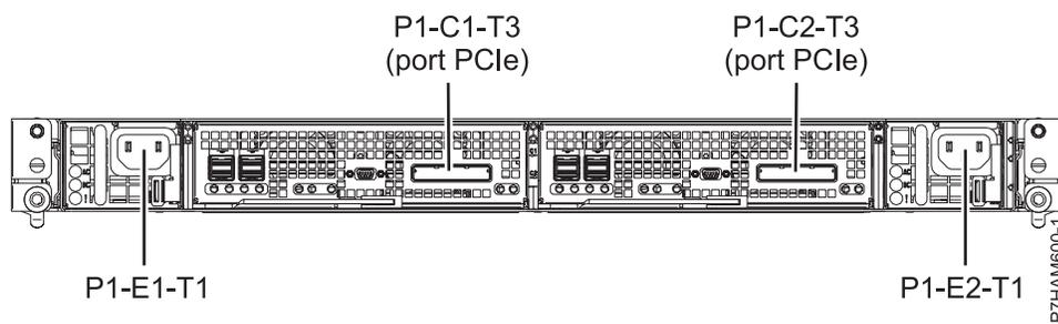
Figure 71. Emplacement des connecteurs sur un modèle ED/R1
