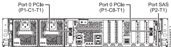
Figure 61. Connexions du modèle 31E/2C pour les boîtiers de stockage PCIe
