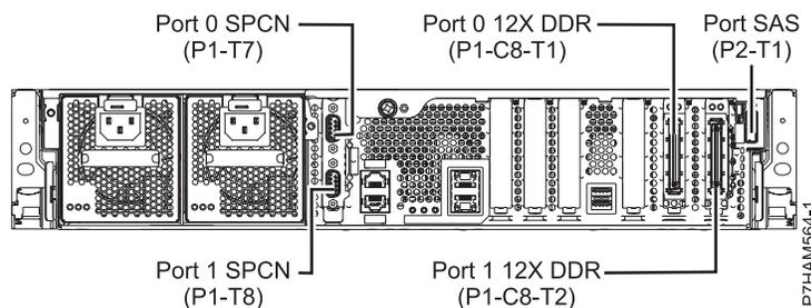
Figure 60. Connexions du modèle 31E/2C pour les unités d'extension et les boîtiers d'unité de disque
