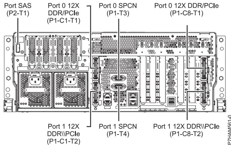
Figure 58. Connexions du modèle 05E/6C pour les unités d'extension, les boîtiers d'unité de disque et les boîtiers de stockage PCIe
