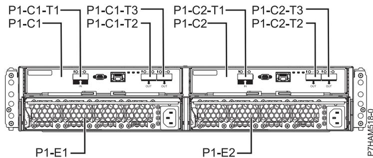
Figure 69. Emplacement des connecteurs sur un modèle 58/87
