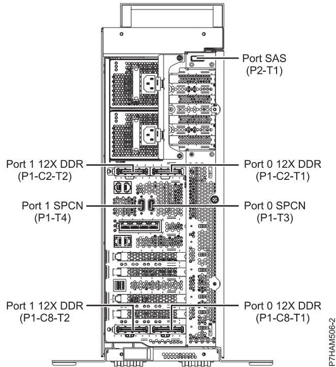
Figure 57. Emplacement des connecteurs sur un modèle 05F/6B autonome
