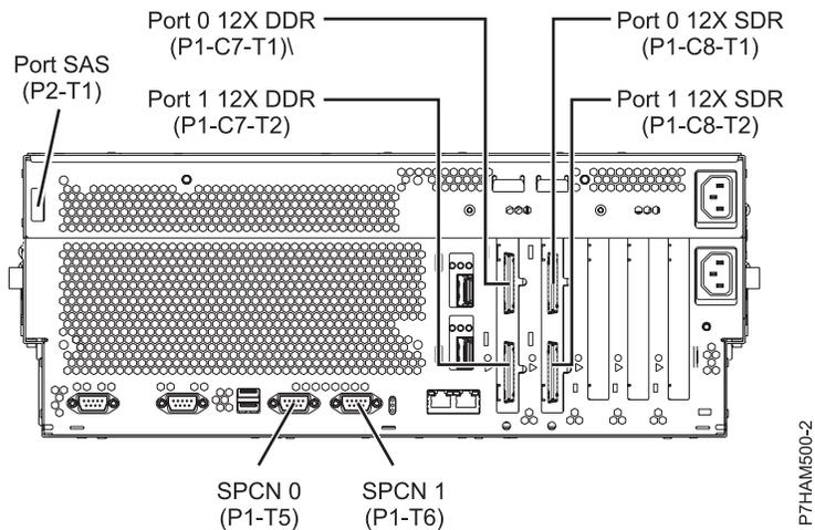
Figure 63. Emplacement des connecteurs sur un modèle 33E/8B monté en armoire
