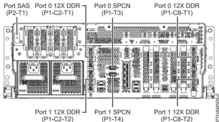
Figure 56. Emplacement des connecteurs sur un modèle 05F/6B monté en armoire
