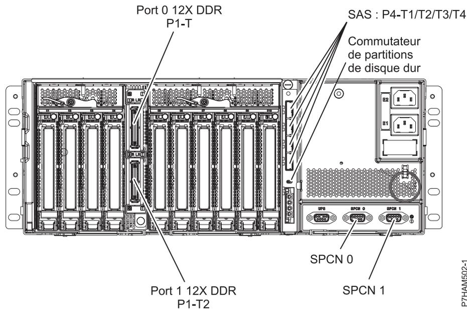
Figure 67. Emplacement des connecteurs sur un modèle 58/02 et 58/77
