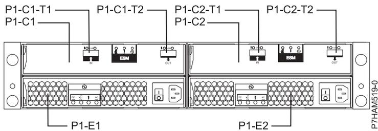
Figure 68. Emplacement des connecteurs sur un modèle 58/86
