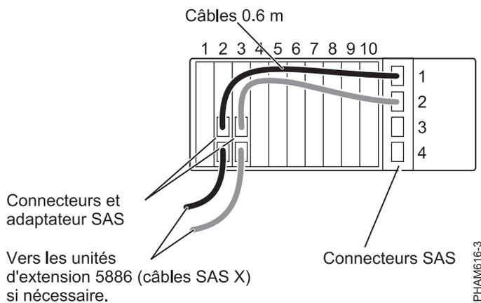
Figure 10. Exemple de câblage physique : 1 partition de disque dur avec 18 disques, deux adaptateurs SAS, commutateur de partitions de disque dur sur la position 1
