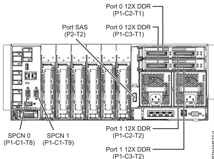
Figure 65. Emplacement des connecteurs sur un modèle 17M/MC, 17M/MD, 79M/HC ou 79M/HD
