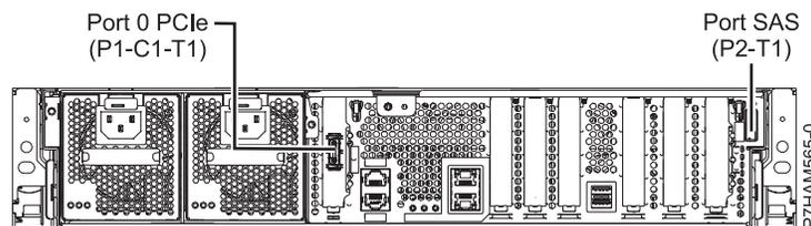
Figure 59. Connexions du modèle 31E/1C pour les boîtiers d'unité de disque et les boîtiers de stockage PCIe
