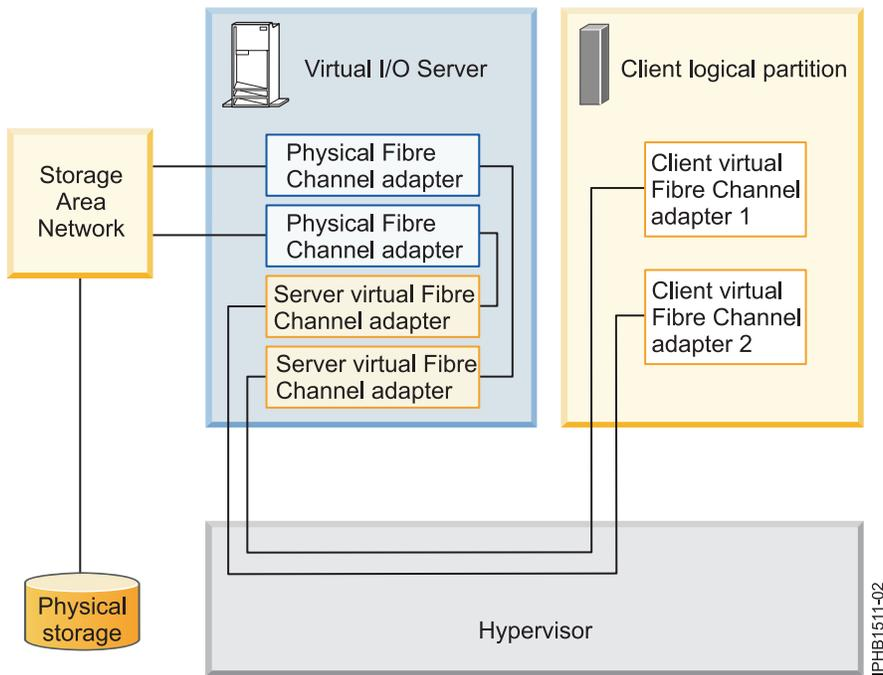
Le client peut écrire dans la mémoire physique via l'adaptateur Fibre Channel virtuel client 1 ou 2. Si un adaptateur Fibre Channel physique fait état d'une défaillance, le client utilise l'autre chemin. Cet exemple ne montre pas de redondance au niveau de la mémoire physique, mais suppose plutôt qu'elle est établie au niveau du réseau de systèmes (SAN).
