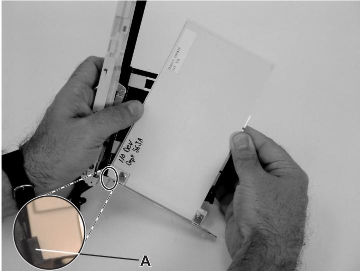
Retirez l'adaptateur ou l'obturateur de finition du bloc-liaison de la cassette en faisant pivoter le bas de la contre-poupée (**A**) pour la sortir (voir illustration). Placez l'adaptateur ou l'obturateur de finition dans un endroit protégé.
