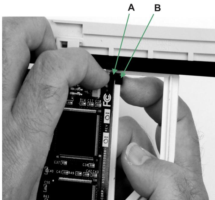
a. Chaque bras de verrouillage d'adaptateur possède une patte de déverrouillage A qui permet d'enlever le bras de l'adaptateur ou de l'obturateur de finition du bloc-cassette. Soulevez la patte avec vos ongles pour retirer chaque bras de l'adaptateur. Soulevez la patte de déverrouillage du bras de l'adaptateur court puis poussez la patte rainurée B pour libérer l'extrémité de l'obturateur de finition.
