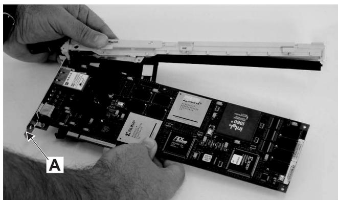
Retirez l'adaptateur du bloc-liaison de la cassette en faisant pivoter le bas de la contre-poupée A pour la sortir (voir illustration). Placez l'adaptateur dans un endroit protégé.
