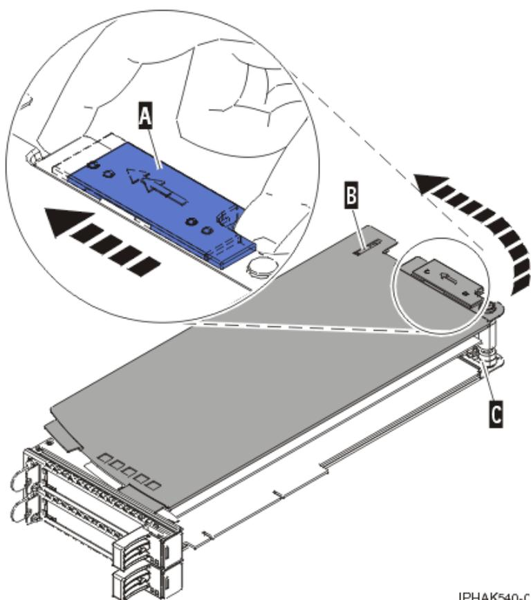
Figure 143. Réinstallation du couvercle de la cassette de cartes PCI
