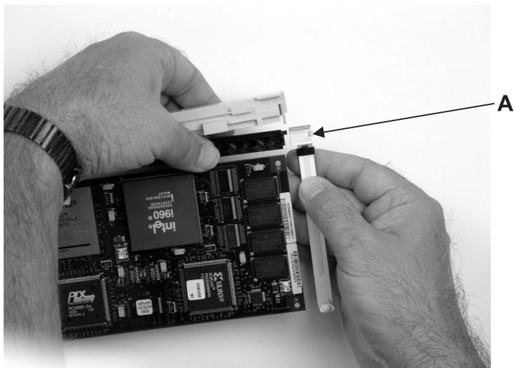
Chaque bras d'adaptateur possède une patte de déverrouillage A qui permet d'enlever le bras de l'adaptateur du bloc-cassette. Soulevez la patte avec vos ongles pour retirer le bras de l'adaptateur. Soulevez la patte de déverrouillage du bras de l'adaptateur long puis glissez-la en dehors du bloc-liaison de la cassette.
