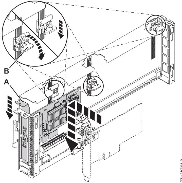
Figure 17. Carte installée dans la cassette de carte PCI simple largeur
