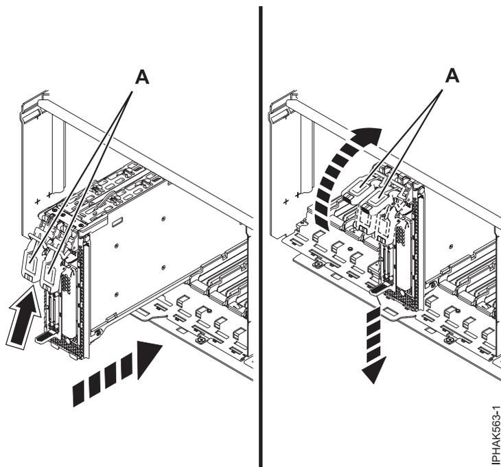
Figure 61. Installation du bloc-cassette dans l'unité d'extension d'entrée-sortie
