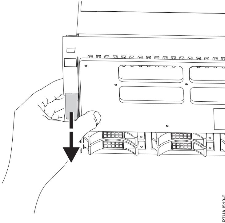
Figure 11. Déblocage des taquets de sécurité du capot
