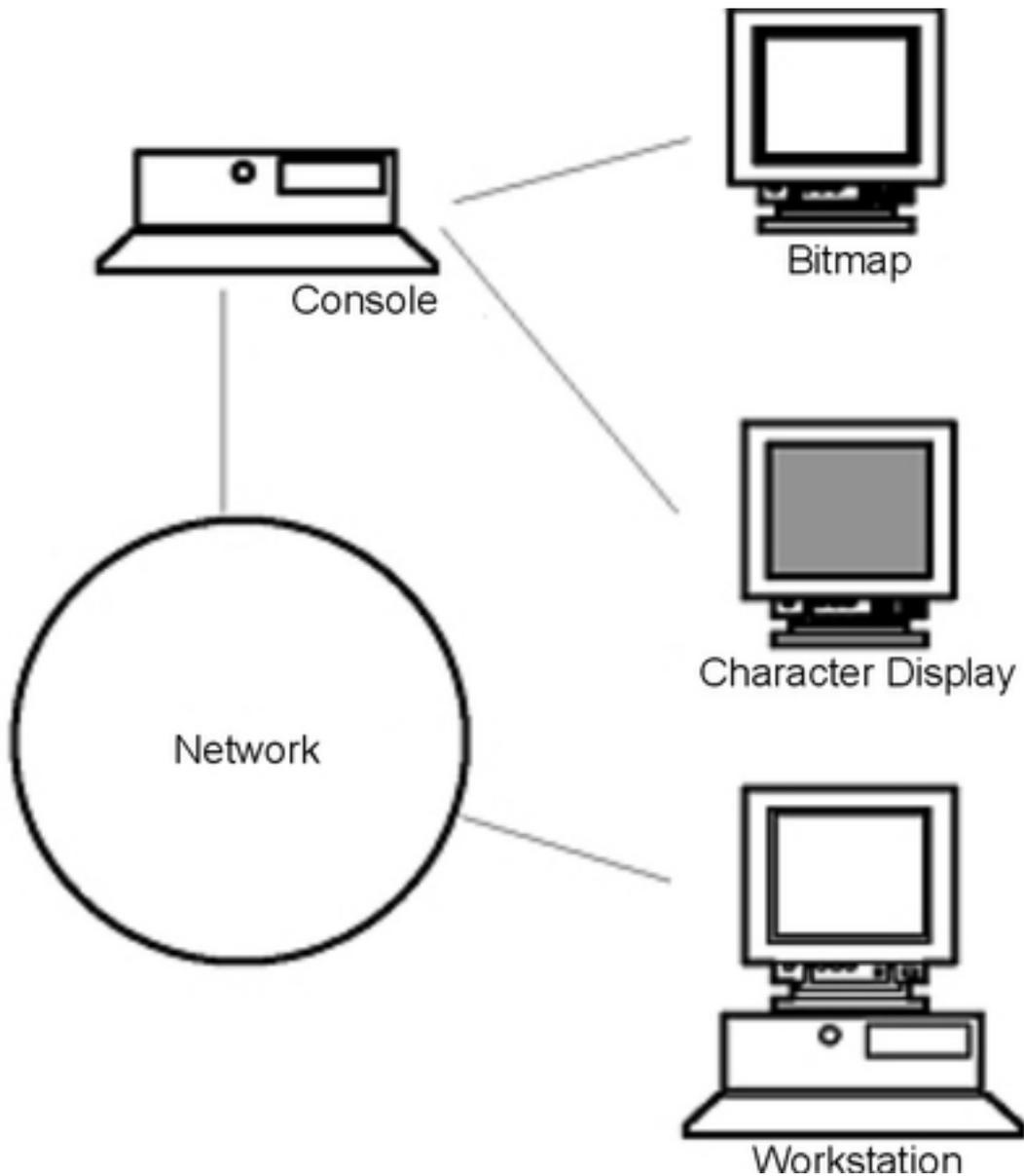
Un terminal X comprend une unité d'affichage, un clavier et une souris qui ne s'exécute que sur le serveur X. Les clients, notamment l'environnement CDE AIX, s'exécutent sur un ou plusieurs systèmes hôtes sur les réseaux. Les sorties client sont dirigées sur le terminal X.
