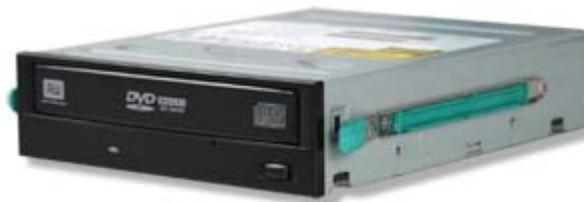
Figure 89: Fixation des rails coulissants
