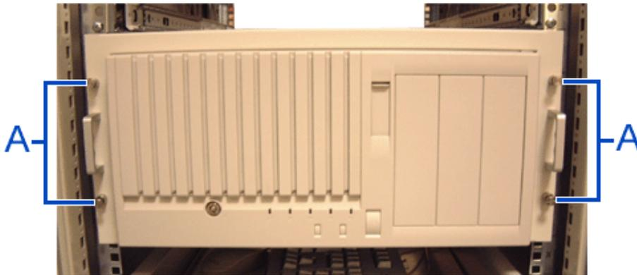
Figure 34: Fixation du serveur au rack
