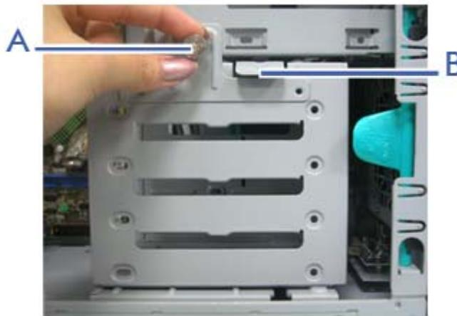
Figure 93: Vis et languette du berceau pour disque dur
