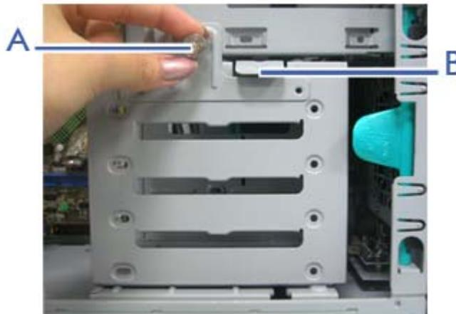
*Figure 91: Vis et languette du berceau pour disque dur*
