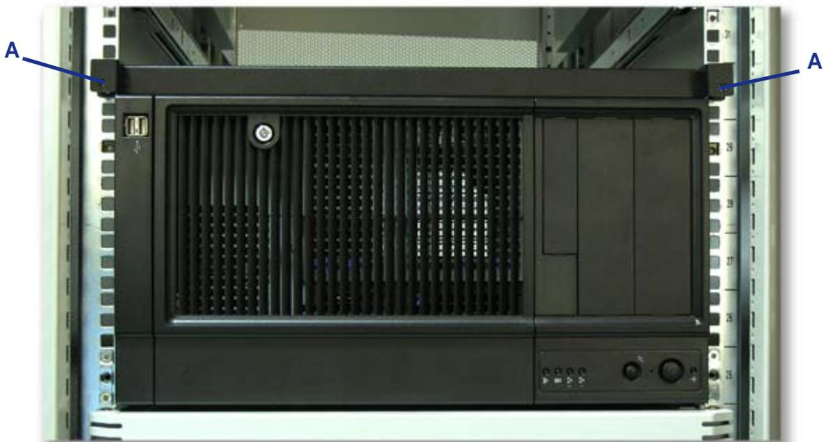
Figure 76: Fixation du serveur au rack
