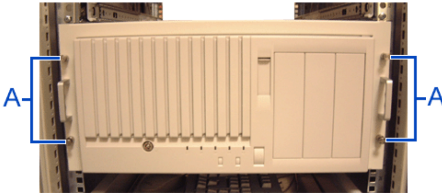
Illustration 34: Fixation du serveur au rack
