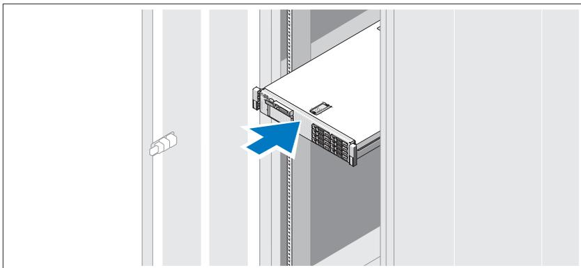
Assemblez les rails et installez le système dans le rack en suivant les consignes de sécurité et les instructions d'installation du rack fournies avec votre système.
