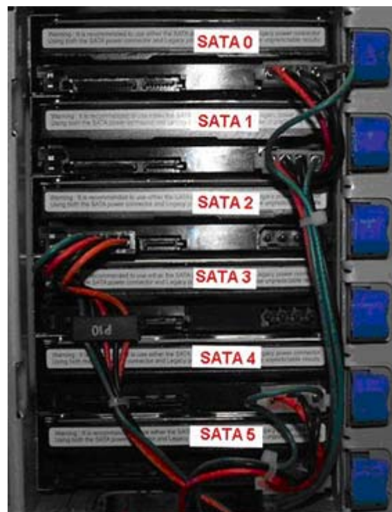
Figure 63: Au moyen d'un port d'alimentation MOLEX
