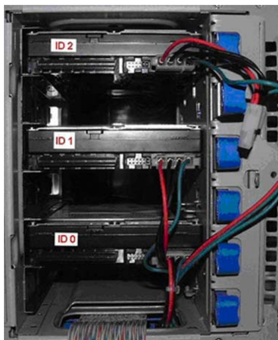
Figure 60: Trois disques durs SCSI installés
