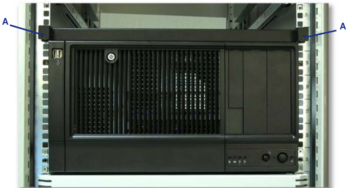
Figure 33: Fixation du serveur au rack
