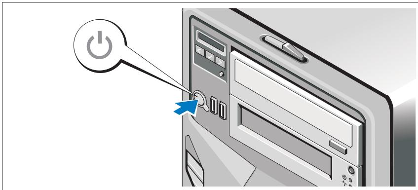
Appuyez sur le bouton de mise sous tension du système. Les voyants d'alimentation doivent s'allumer.
