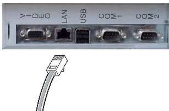
Figure 58. Connexion réseau 10/100 Mo/s
