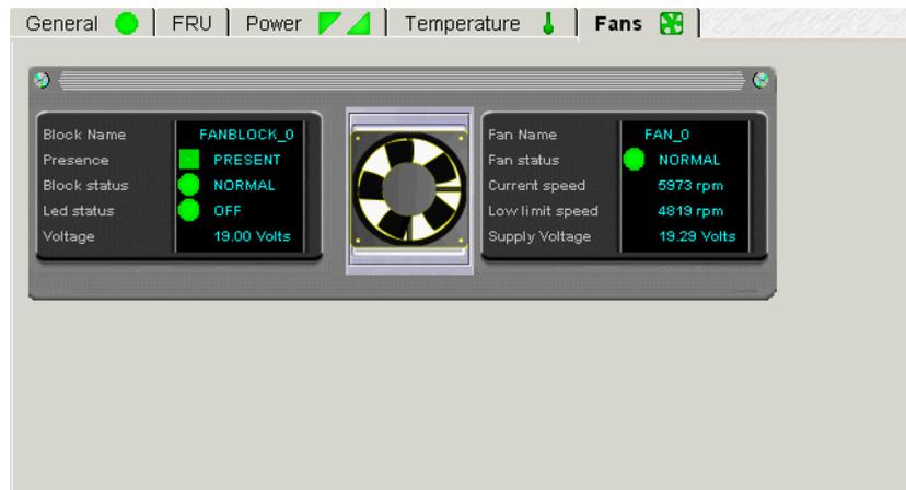
Figure 95. Détails d'un bloc ventilateur (exemple)
