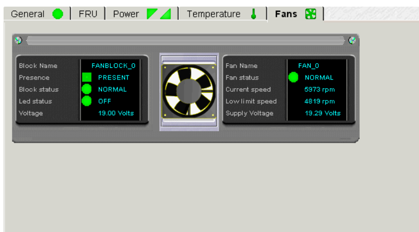
Figure 112. Détails d'un bloc ventilateur (exemple)
