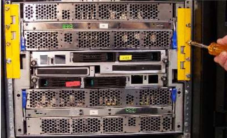
Figure 2. Retrait des cales de transport avant
