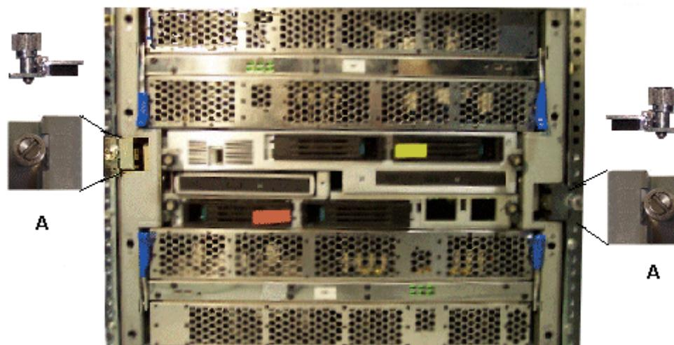
Figure 4. Installation des butées avant
