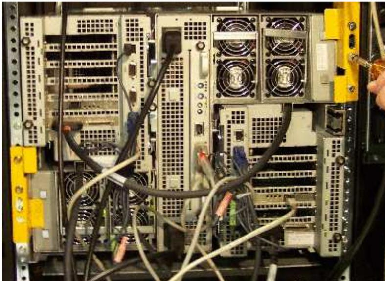
Figure 3. Retrait des cales de transport arrière
