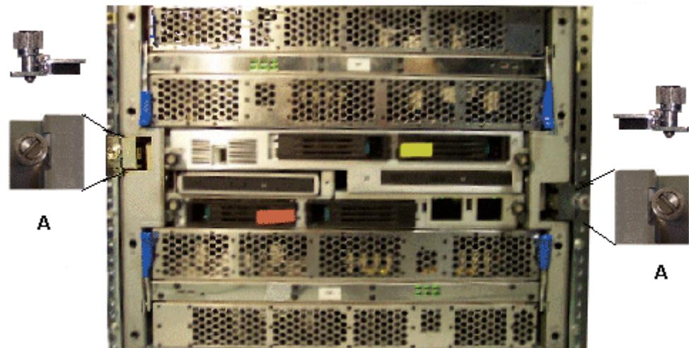
Figure 4. Installation des butées avant
