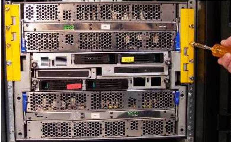
Figure 2. Retrait des cales de transport avant
