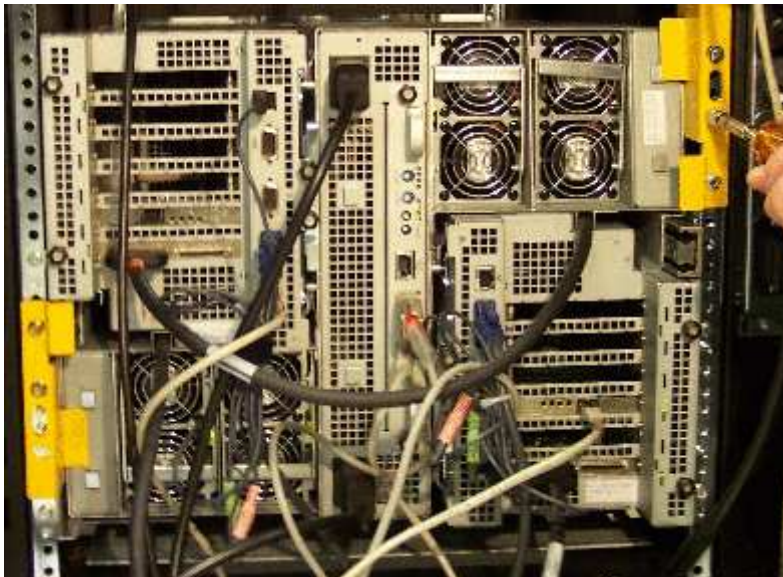
Figure 3. Retrait des cales de transport arrière
