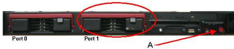
Figure 54. Retrait du disque de droite
