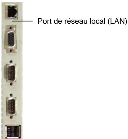
Figure 48. Port de réseau local 10/100/1000 Mb/s
