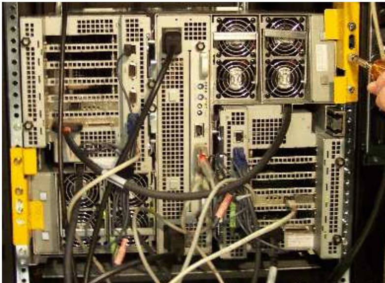
Figure 3. Retrait des cales de transport arrière
