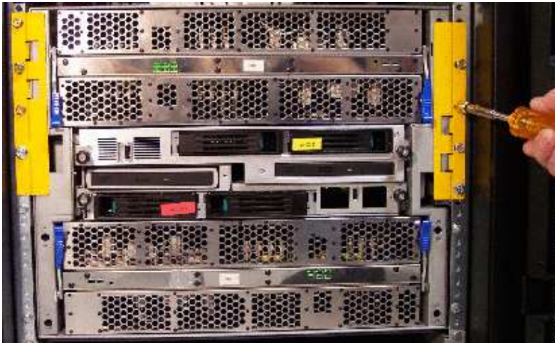
Figure 2. Retrait des cales de transport avant
