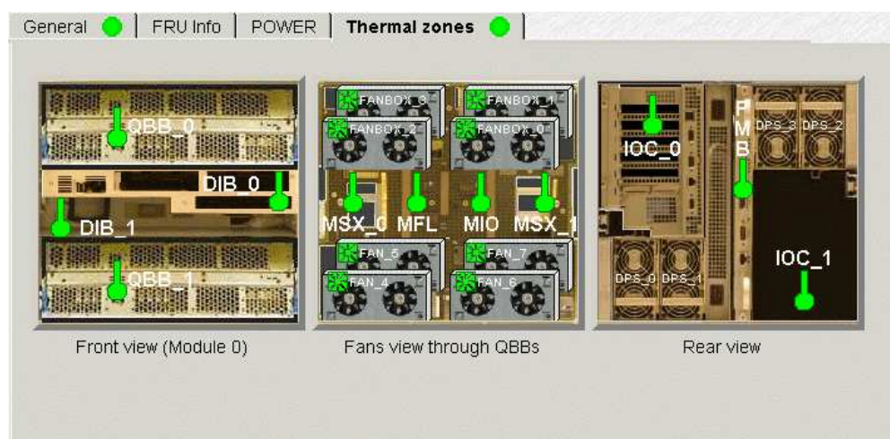
Figure 104. Détails des zones thermiques du module CSS
