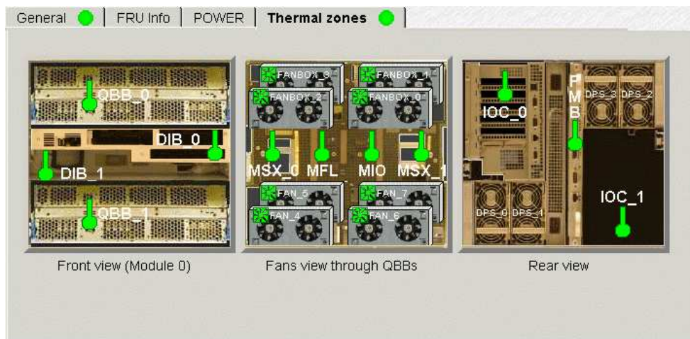
Figure 71. Détails des zones thermiques du module CSS
