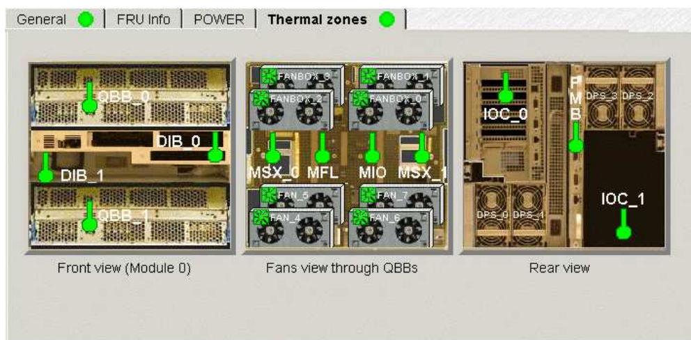
Figure 71. Détails des zones thermiques du module CSS
