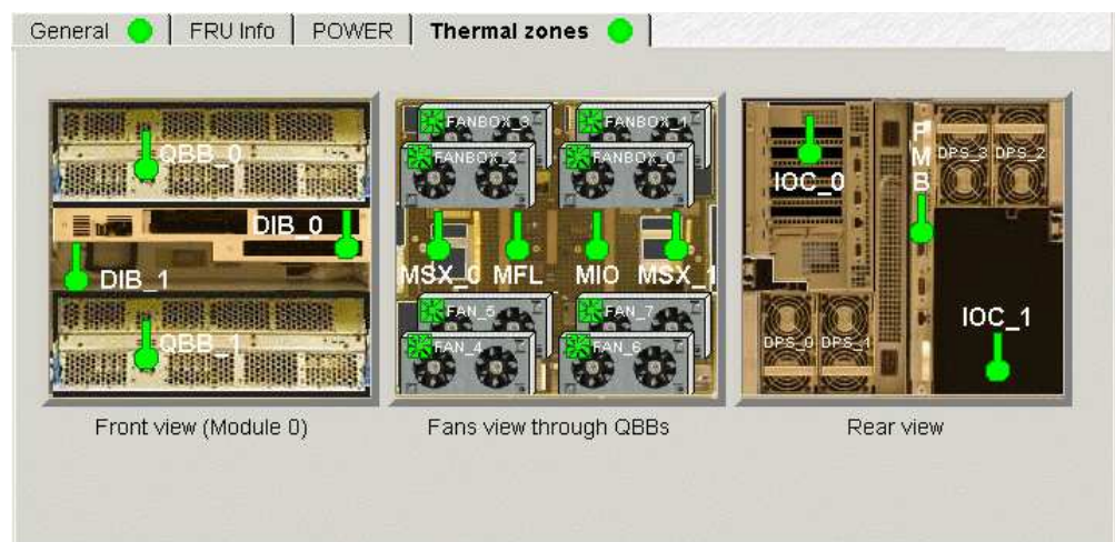
Figure 71. Détails des zones thermiques du module CSS
