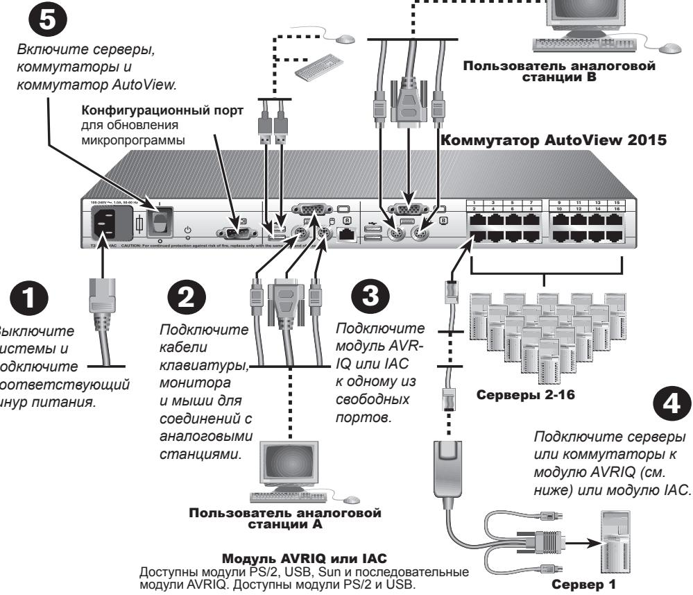
**ПРИМЕЧАНИЕ.** Ограничение длины кабеля до 100 футов (30 метров) зависит от качества кабеля и факторов окружающей среды.
