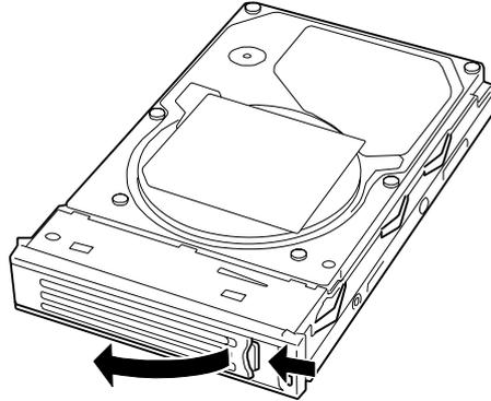
*Figure 100: Déverrouillage de la poignée du disque dur*
