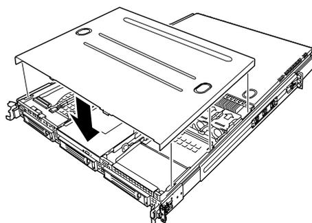
Figure 111: Installation du capot du disque du châssis
