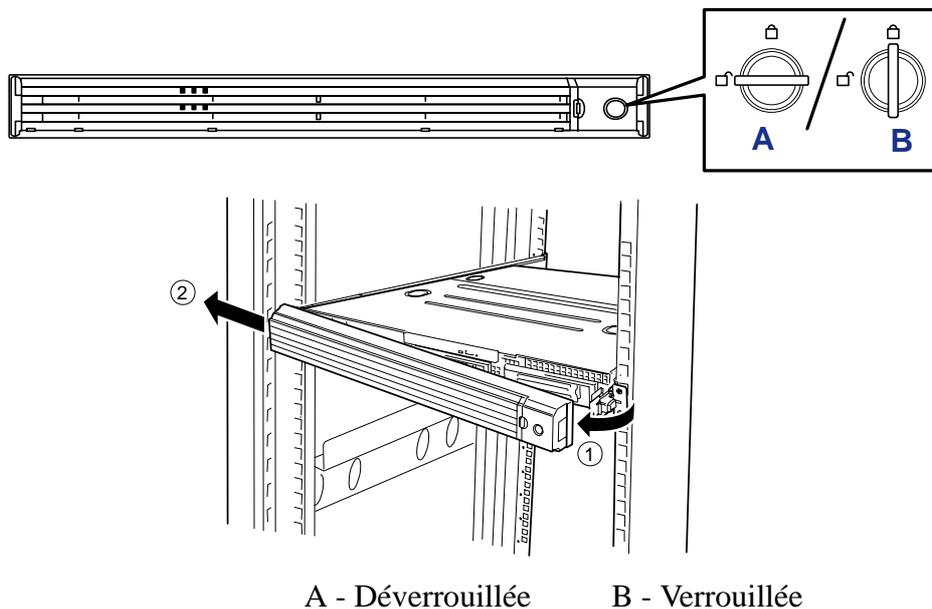
Figure 95: Déverrouillage et retrait de la façade
