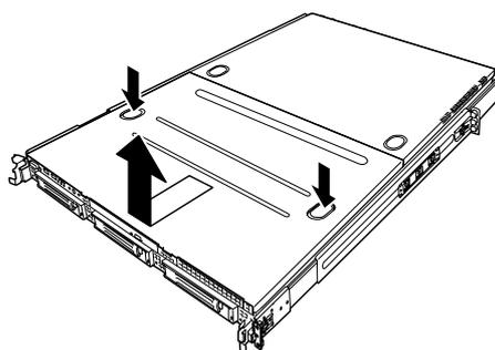
Figure 110: Retrait du capot du disque du châssis
