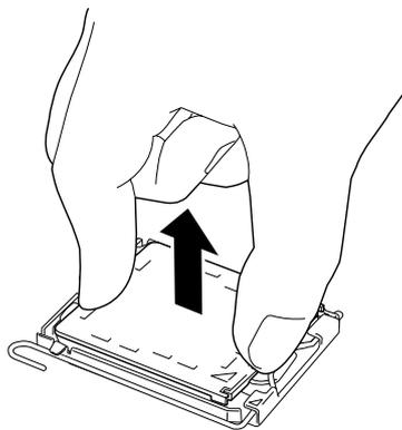
Figure 122: Retrait du cache de protection du connecteur
