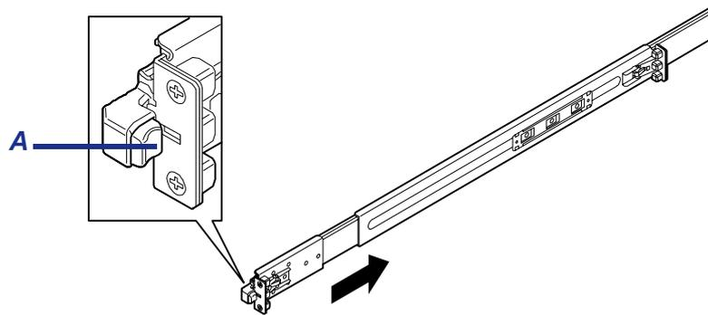
**Figure 13: Déplacement des rails vers l'arrière du serveur**
