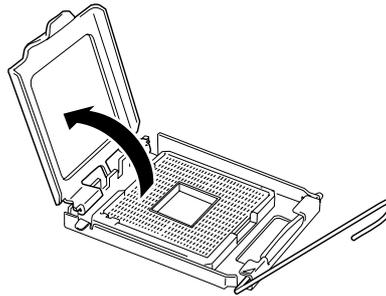
Figure 124: Ouverture du clip de fixation
