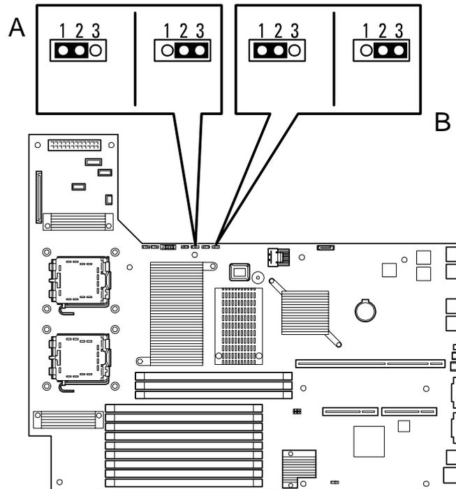
Figure 94: Cavaliers d'effacement de la CMOS et de suppression du mot de passe
