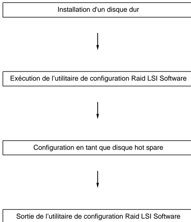
1. Installez un disque dur qui sera utilisé en tant que disque hot spare et mettez le serveur sous tension.
