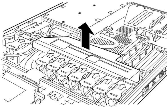
Figure 121: Retrait du conduit d'aération du processeur
