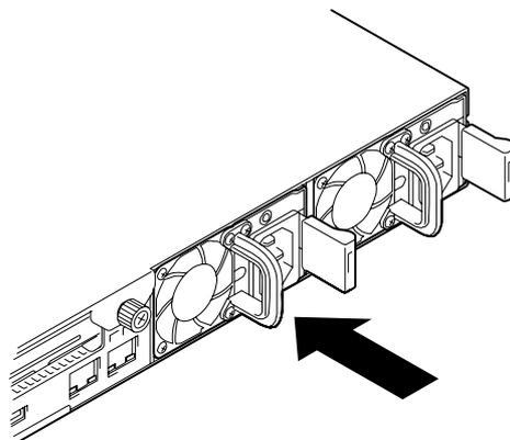
Figure 106: Verrouillage de l'unité d'alimentation
