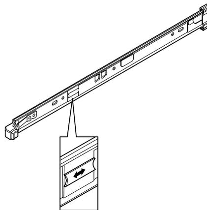
Figure 97: Leviers de déverrouillage poussés
