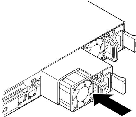
Figure 105: Insertion de l'unité d'alimentation dans le serveur
