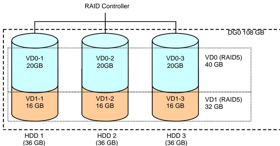
Figure 32: Exemple de configuration de disque virtuel
