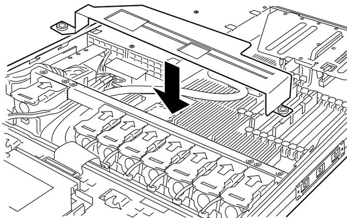
Figure 129: Installation du conduit de ventilation du processeur
