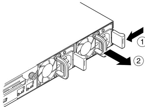
**Figure 109: Retrait de l'alimentation du châssis**
