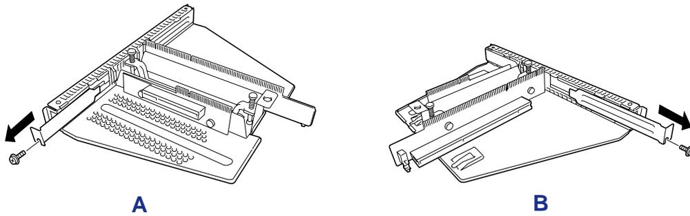
Figure 135: Retrait du cache de slot d'extension
