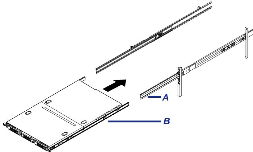
Figure 19: Insertion du serveur dans le rack
