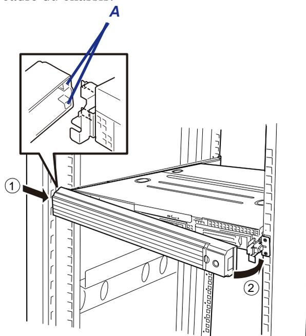
Figure 21: Installation de la façade
