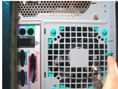
Figure 24: Languette de retrait du panneau latéral droit
