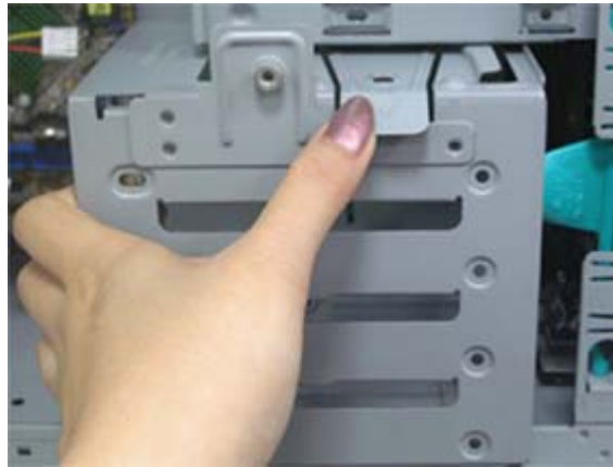
Figure 29: Retrait du berceau pour disque dur
