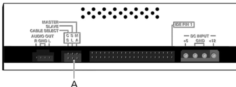
Figure 97: Connecteurs situés au dos d'un lecteur optique (exemple)
