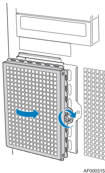
Figure 55: Réinstallation de l'écran EMI du panier de disque dur
