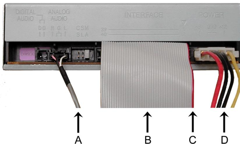
*Figure 89: Câblage d'un périphérique optique IDE*
