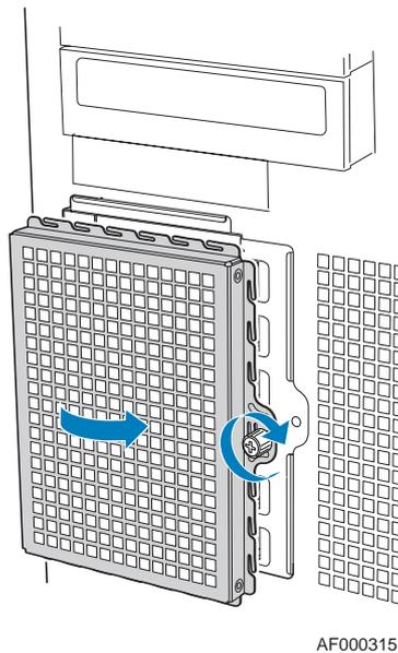
**Figure 60: Réinstallation de l'écran EMI du panier de disque dur**
