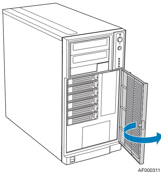
Figure 61: Ouverture de la porte d'accès aux baies de disque
