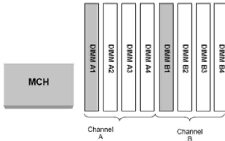
Figure 14: Configuration avec deux modules de mémoire DIMM
