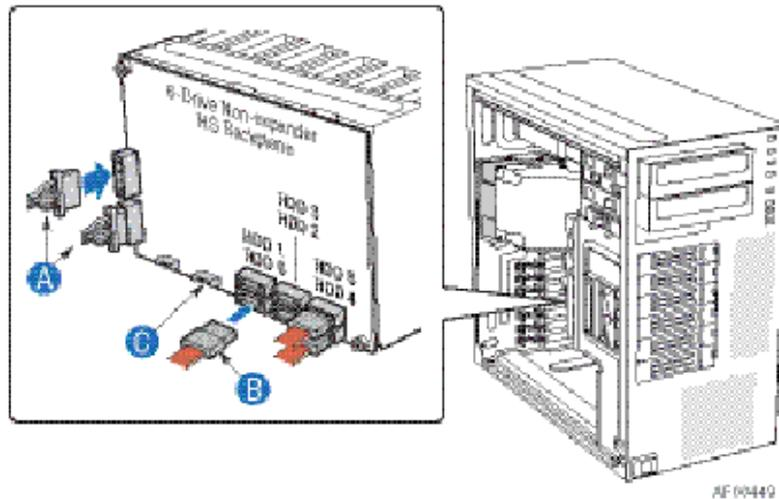
*Figure 70: Branchement du panier de six disques durs 'hot-swap' SAS/S-ATA
