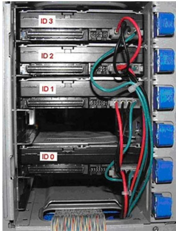
Figure 51: Quatre disques durs SCSI installés
