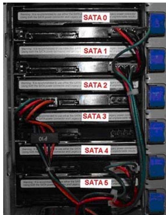
Figure 53: Au moyen d'un port d'alimentation MOLEX
