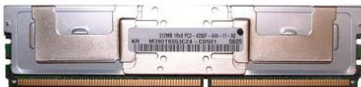
Figure 80: Exemple de module de mémoire FB-DIMM DDR2
