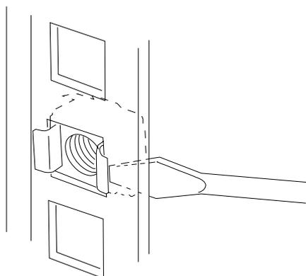
**Figure 30: Insertion d'un écrou en cage**
