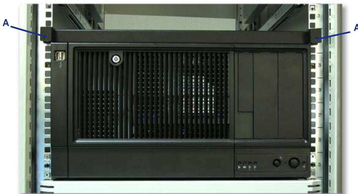
Figure 32: Fixation du serveur au rack
