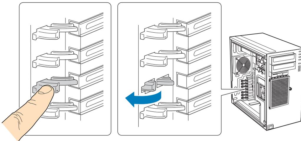
**Figure 84: Ouvrir le Mécanisme de Rétention pour Cartes PCI**
