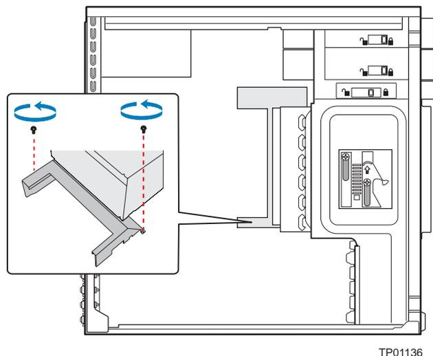
**Figure 73: Retrait du conduit d'aération grand format (Part A)**
