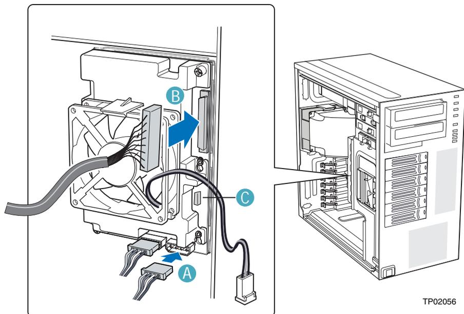
Figure 72: Câblage du panier de disque dur 'hot-swap' SCSI
