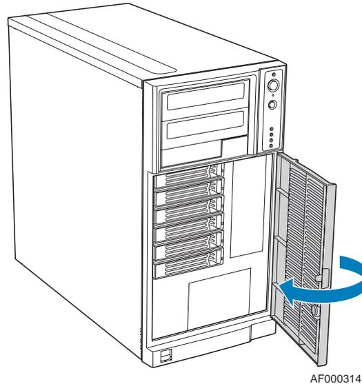
Figure 67: Fermeture de la porte d'accès aux baies de disque
