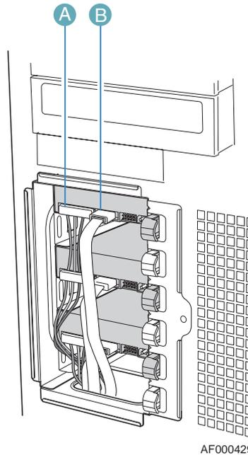
Figure 54: Câblage d'un disque dur fixe
