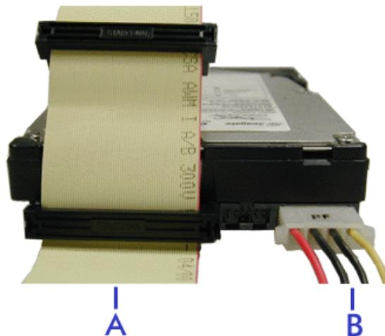
Figure 90: Câblage d'un disque dur SCSI
