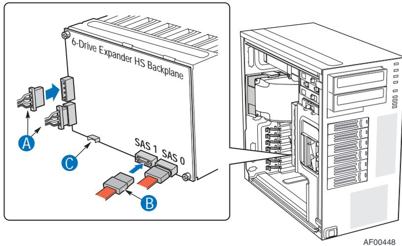
**Figure 71: Branchement du fond de panier de six disques durs 'hot-swap' avec extenseur**
