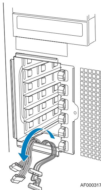
Figure 46: Acheminement des câbles d'alimentation des disques durs
