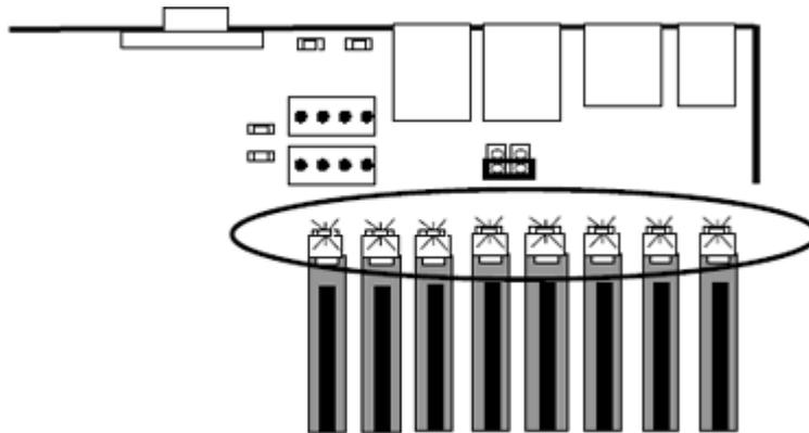
Figure 101: Témoins de panne des modules DIMM
