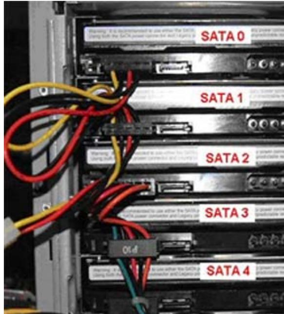
Figure 52: Au moyen d'un adaptateur électrique S-ATA/MOLEX
