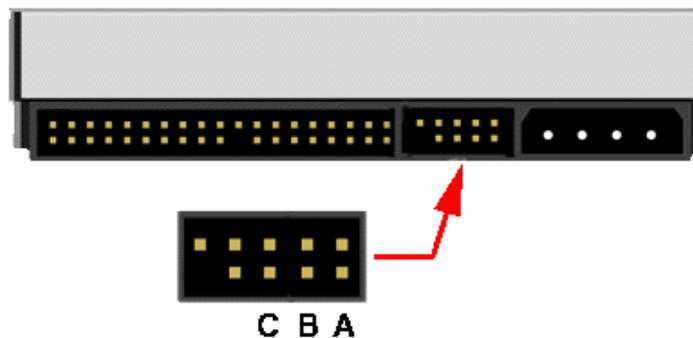
*Figure 99: Connecteurs situés au dos d'un lecteur de bandes (exemple)*
